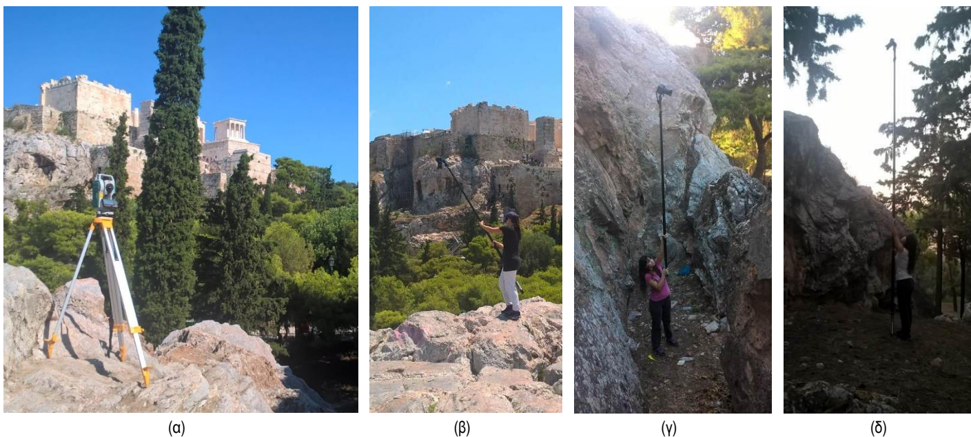
Εικόνα 32: Στιγμιότυπα από τις εργασίες υπαίθρου, (α) Τοπογραφικές μετρήσεις, (β) Φωτογράφιση κορυφής λόφου από τον αέρα, (γ) Φωτογράφιση βράχων δεύτερης σειράς με το ένα στέλεχος του κονταριού, (δ) Φωτογράφιση βράχων τρίτης σειράς και με τα δύο στελέχη του κονταριού
