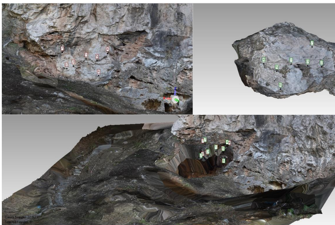
Εικόνα 69: Χειροκίνητη Συναρμολόγηση βράχου 1A με την πλαγιά του λόφου
