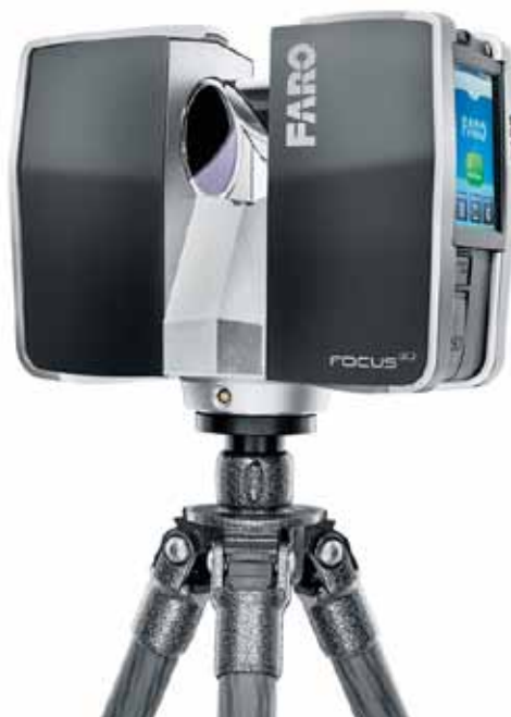
εικ. 14. Ο σαρωτής laser FOCUS 3D της εταιρίας FARO
