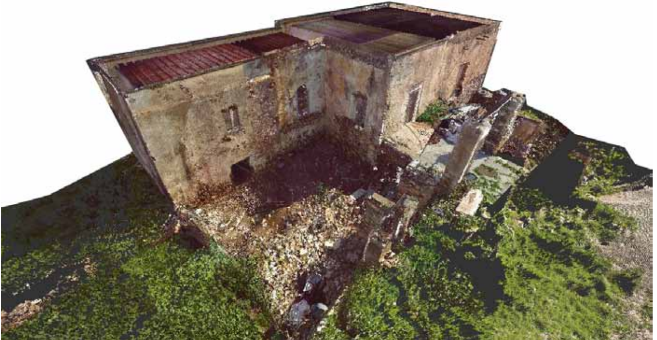
εικ. 13. Τρισδιάστατη απεικόνιση του κτιρίου μετά την επεξεργασία του “νέφους” σημείων.
