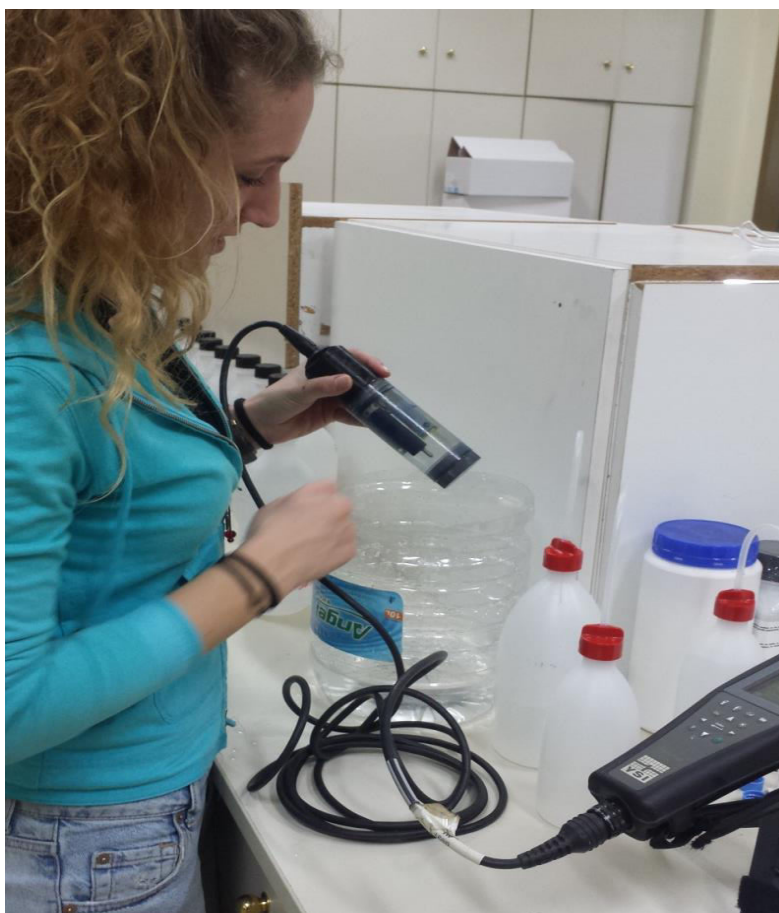
Εικόνα 3.4: Διαδικασία υπολογισμού των φυσικοχημικών παραμέτρων με πολύμετρο.
