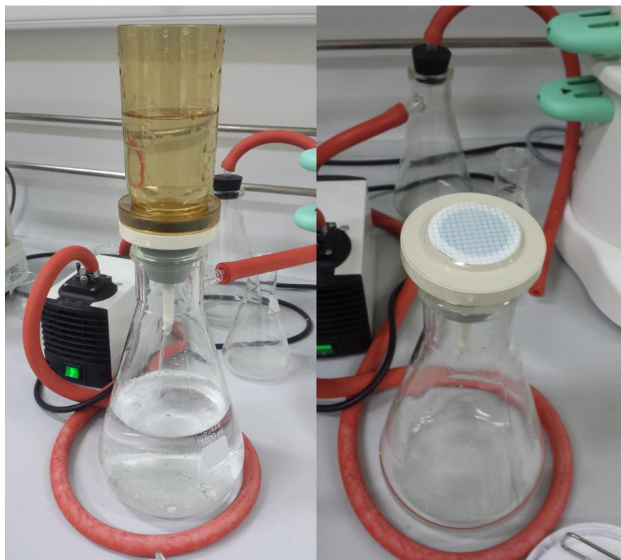
Εικόνα 3.2: Εξαρτήματα και διαδικασία διήθησης των δειγμάτων μέσω ηθμών.
