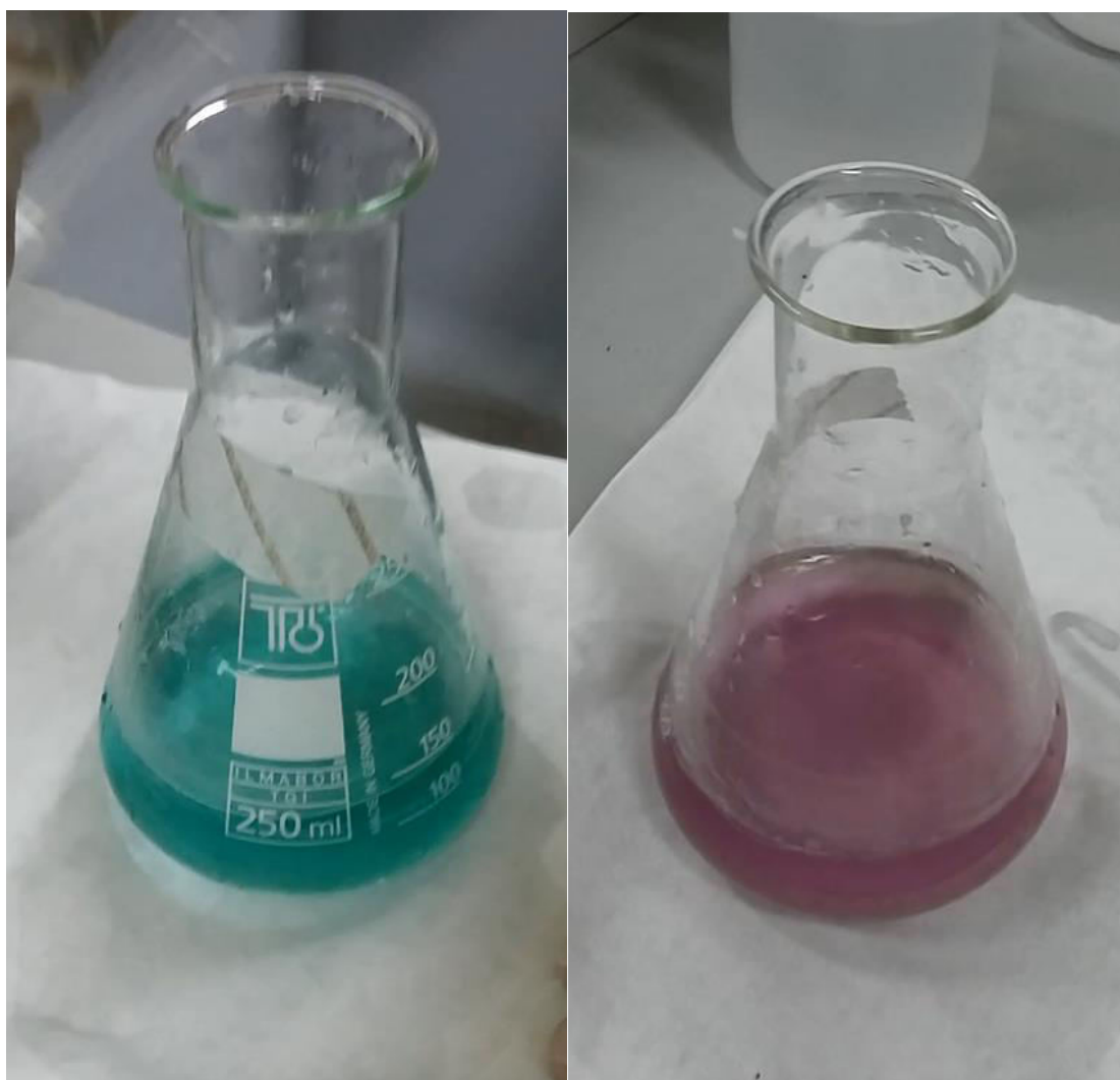
Εικόνα 3.8: Αριστερά το δείγμα με την προσθήκη του δείκτη bromocresol και δεξιά το δείγμα μετά την τιτλοδότηση με θειικό οξύ.
