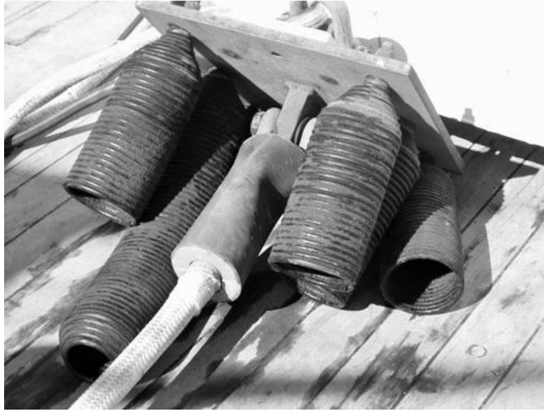
Εικόνα 2: Διάβρωση μεταλλικών ελατηρίων μετά από τοποθέτηση στη θάλασσα χωρίς προστασία [6].
