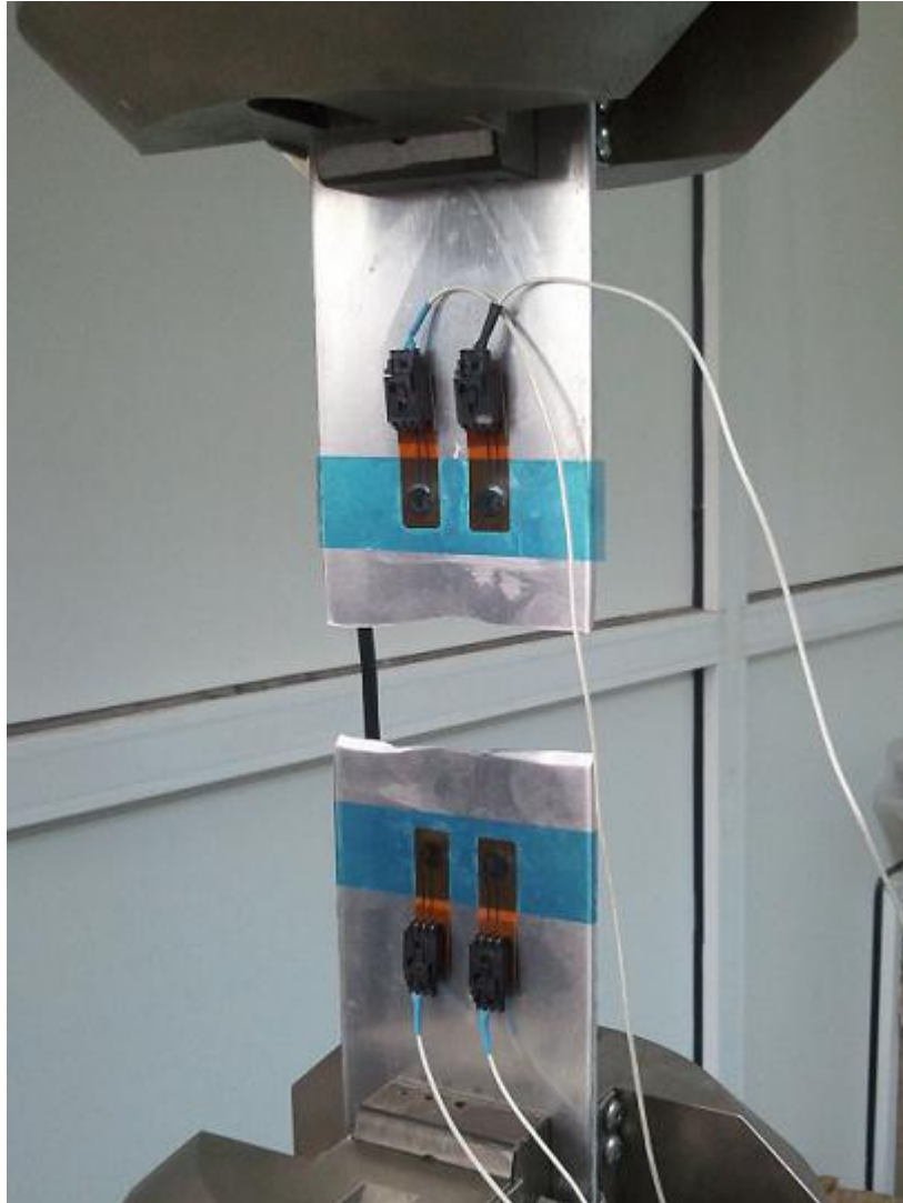
Εικόνα 6.15. Δοκίμιο αλουμινίου που αστόχησε μετά από κόπωση 18900 κύκλων
