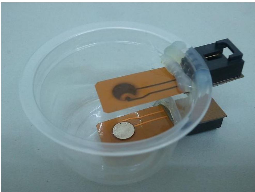
Εικόνα 6.22. Πλαστικό κύπελλο με δύο πιεζοηλεκτρικούς αισθητήρες προσαρμοσμένους.
