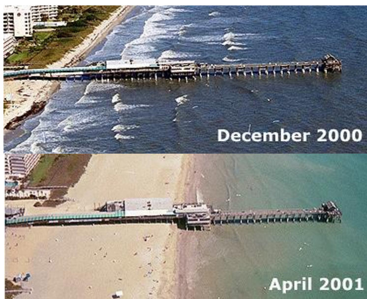
Εικόνα 8.7: Τεχνητή ανάπλαση/ εμπλουτισμός ακτής, Brevard beach, Florida
