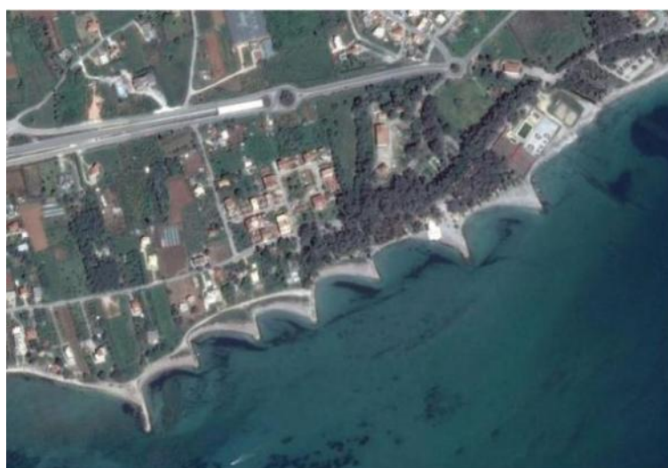
Εικόνα 8.2: Μόνιμοι πρόβολοι συγκράτησης ακτογραμμής, Πρέβεζα
