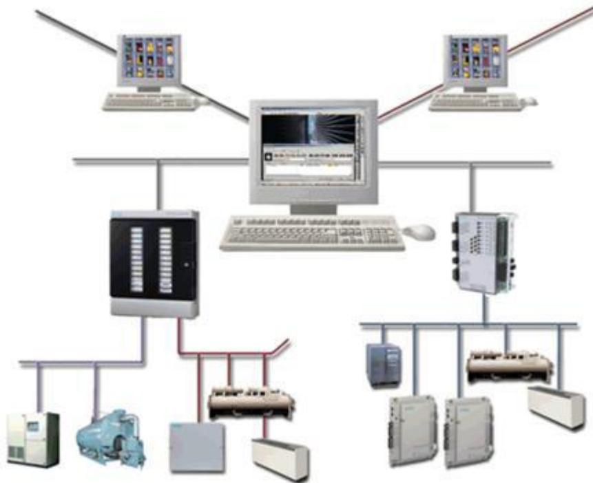
Σχήμα 3.4 Δίκτυο Συσκευών ΒΕΜΣ
