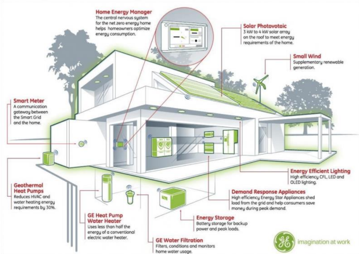
Σχήμα 2.2 "Εξυπνο" Κτήριο με σύστημα BEMS
