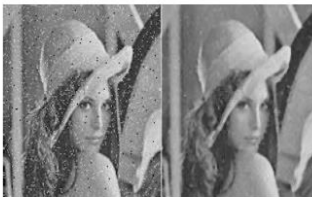
Εικόνα 8. Φίλτρο διαμέσου. Αριστερά Πριν, Δεξιά μετά
