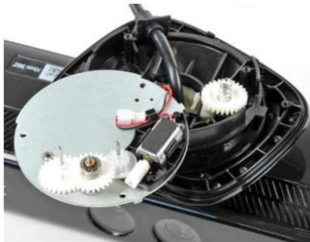
Εικόνα 24. Μηχανισμός tilt εσωτερικά
