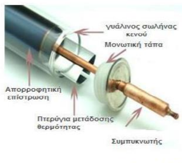
Σχήμα 2.16 : Θερμικός σωλήνας του εμπορίου
