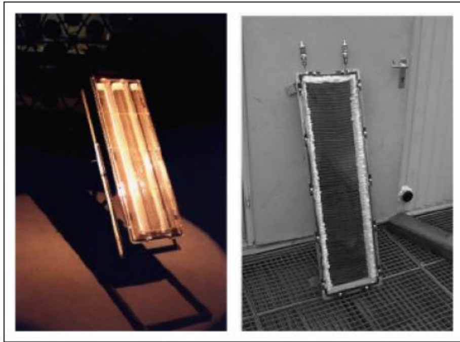
Σχήμα 2.20 : Θερμικός σωλήνας λεπτής μεμβράνης
