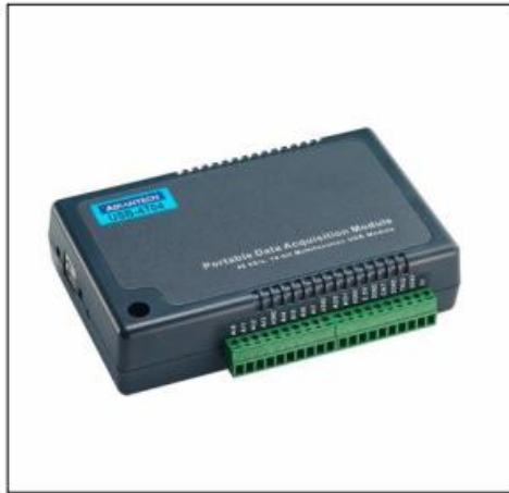
Σχήμα 5-4 Αναλογοψηφιακός μετατροπέας USB-4704 [18]
