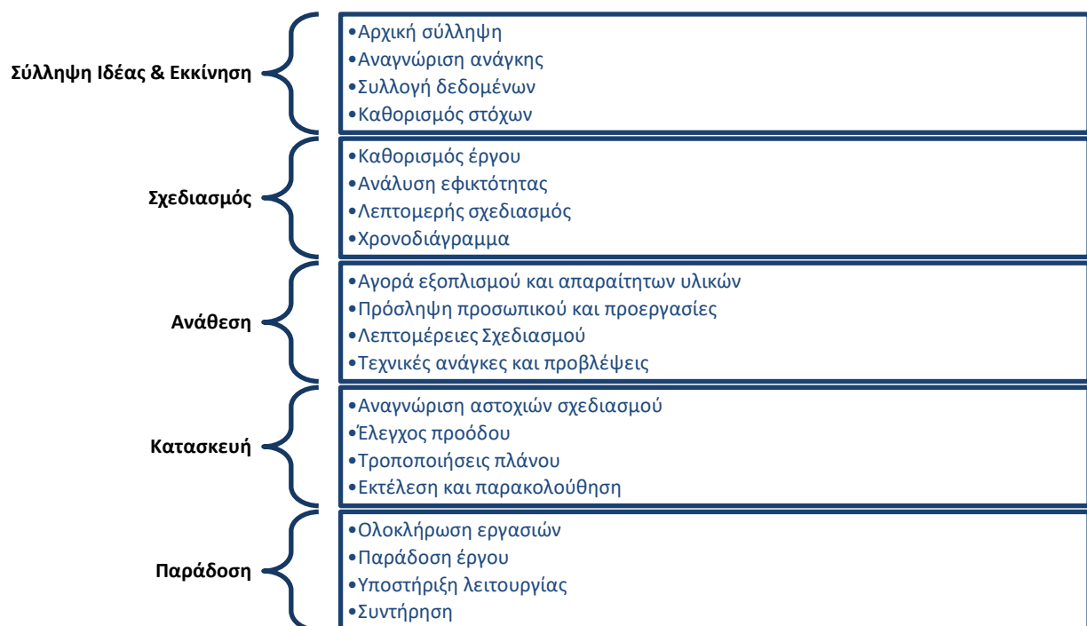
Σχήμα 2.2: Φάσεις κατασκευαστικού έργου
