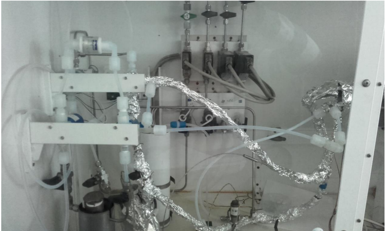
Εικόνα 4.6 : Σύστημα σωληνώσεων παροχής των αερίων
