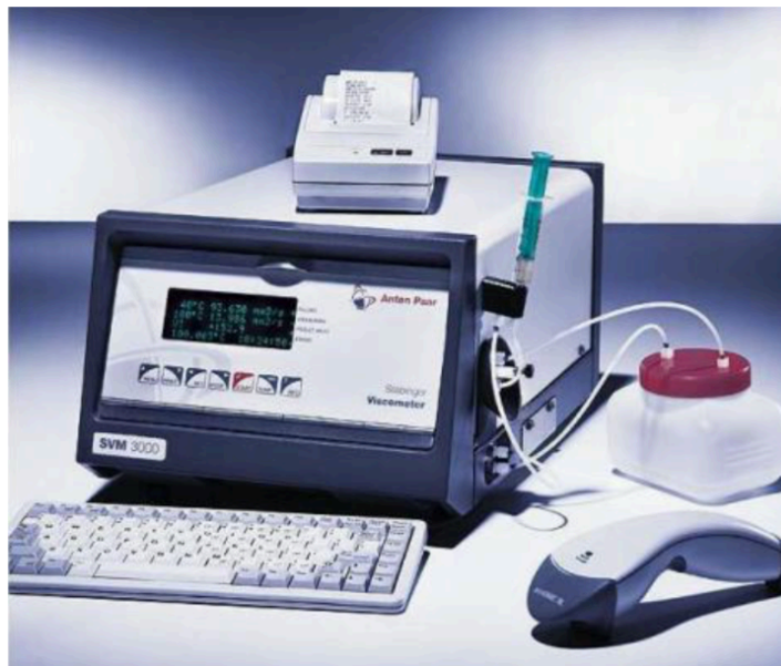
Εικόνα 5: SVM 3000 Stabinger Viscometer της Anton Paar
