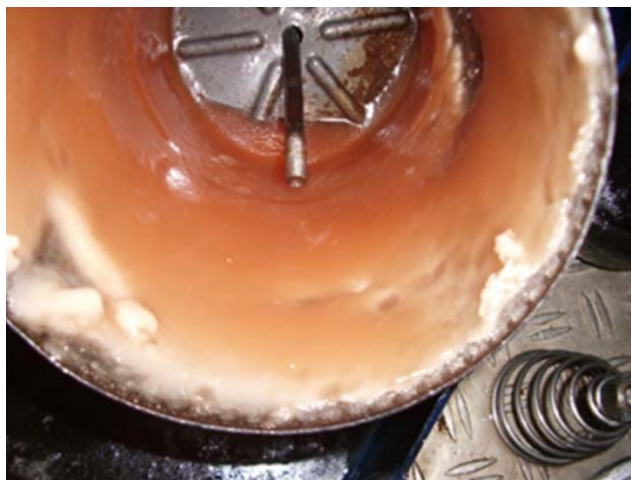
Εικόνα 1: Μπλοκαρισμένο φίλτρο λόγω διαχωρισμού παραφίνης στο καύσιμο. [7]
