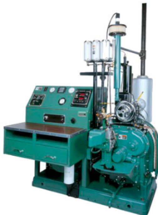
Εικόνα 2: Ο πρότυπος κινητήρας CFR
