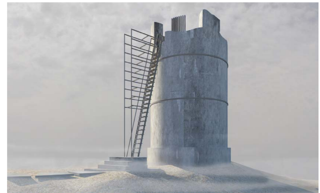
εικ.188_Π09, άποψη της νέας μεταλλικής κλίμακας ανόδου στο δώμα (τριδιάστατη απεικόνιση)
