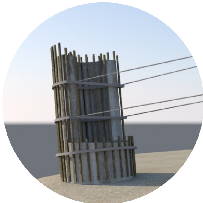
εικ.206_ κλωβός από μεταλλικούς δακτυλίους και κατακόρυφα τοποθετημένες ξύλινες δοκούς, τρισδιάστατη απεικόνιση
