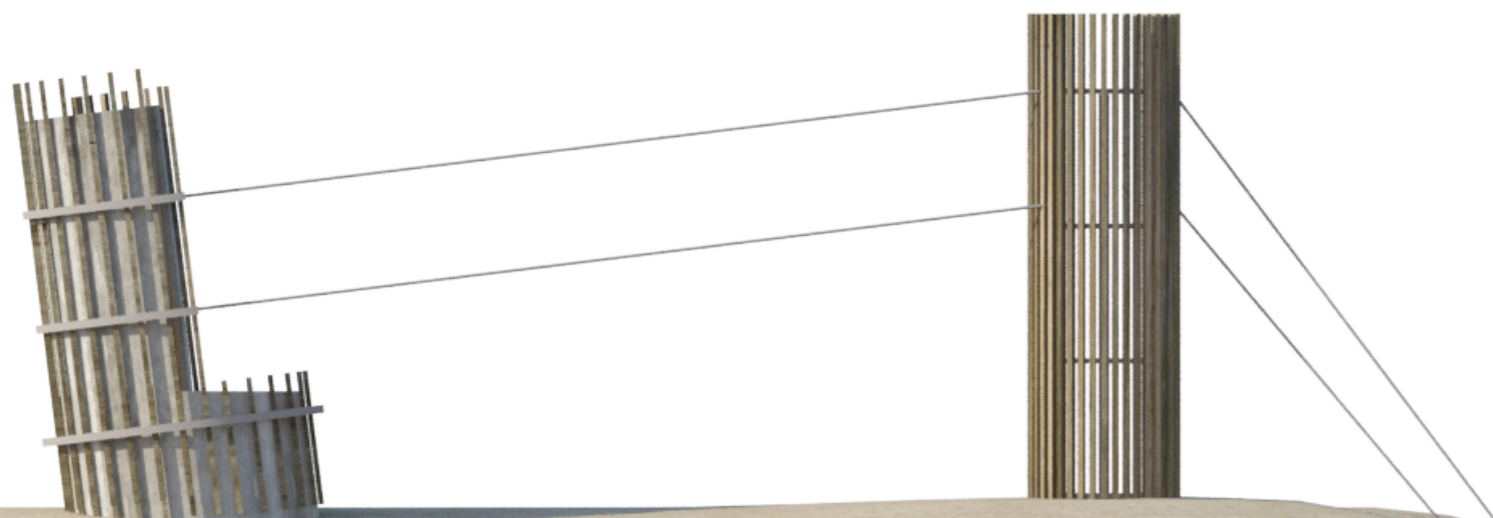
εικ.205_ Π10, κατασκευή στήριξη του πύργου (άμεσα σωστικά μέτρα) τρισδιάστατη απεικόνιση
