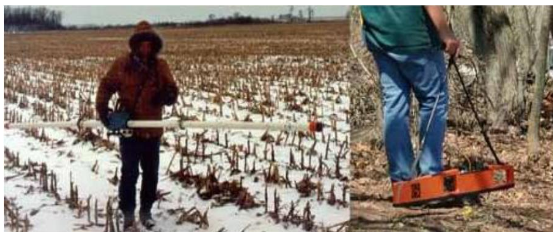
Εικόνα 2.1: Ενδεικτικά μηχανήματα Ηλεκτρομαγνητικής Μεθόδου. Στο αριστερό μέρος είναι το EM-31, και στο δεξί μέρος είναι το EM-38 ( http://geonicsrental.com/ )
