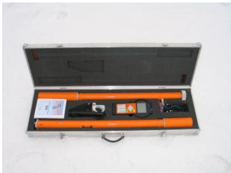
Εικόνα 4.13: Το ηλεκτρομαγνητικό όργανο CMD της GF instruments (CMD , Electromagnetic Conductivity Meter User Manual)
