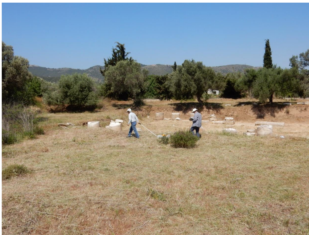
Εικόνα 4.24: Λήψη μετρήσεων γεωραντάρ στην περιοχή της Αρχαίας Αγοράς του Θορικού από τους κυρίους Αποστολόπουλο και Αμολοχίτη
