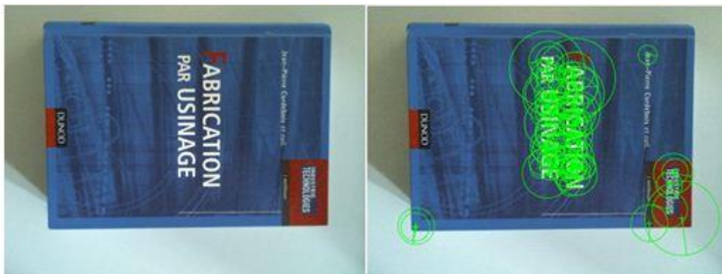
Σχήμα 4.14: Εύρεση χαρακτηριστικών σημείων σε ένα τυπικό εξώφυλλο βιβλίου και σημείωση των 100 πρώτων σε αυτό.
