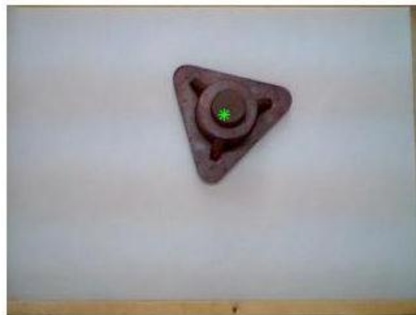
Σχήμα 4.44: Εύρεση του κέντρου του αντικειμένου στην εικόνα αναζήτησης.
