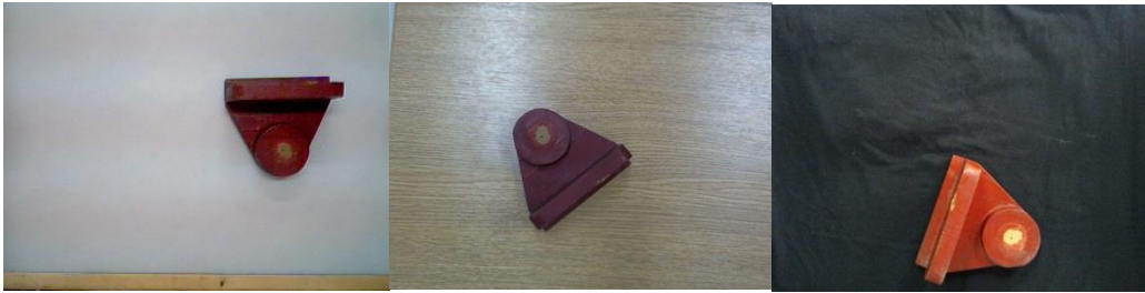
Σχήμα 4.13: Εικόνες που χρησιμοποιήθηκαν για να ελεγχθεί πόσο επηρεάζει η ανάλυση την εύρεση των χαρακτηριστικών σημείων (Παρουσιάζονται με αύξουσα σειρά ως προς την ανάλυση).
