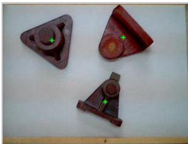
Σχήμα 3.17: Εκτίμηση κέντρων μάζας αντικειμένων με χρήση της εντολής regionprops .
