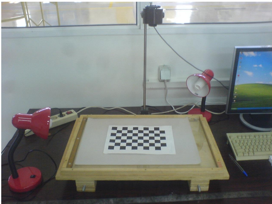
Σχήμα 4.1: Διάταξη λήψης εικόνων μέσω κάμερας.
