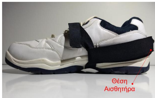
Σχήμα 4-30. Διάταξη πρόσδεσης αισθητήρα στο παπούτσι (πλάγια όψη).
