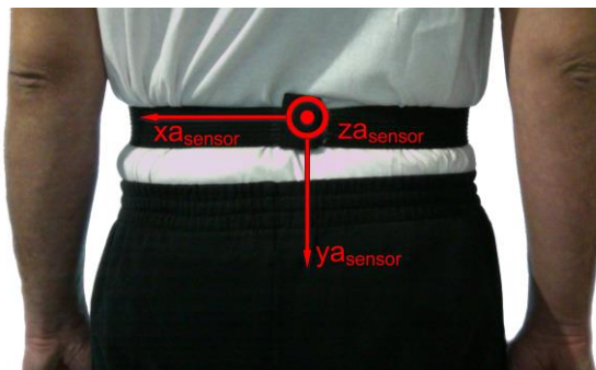
Σχήμα 4-35. Διάταξη πρόσδεσης αισθητήρα στη μέση (τοποθέτηση - άξονες).
