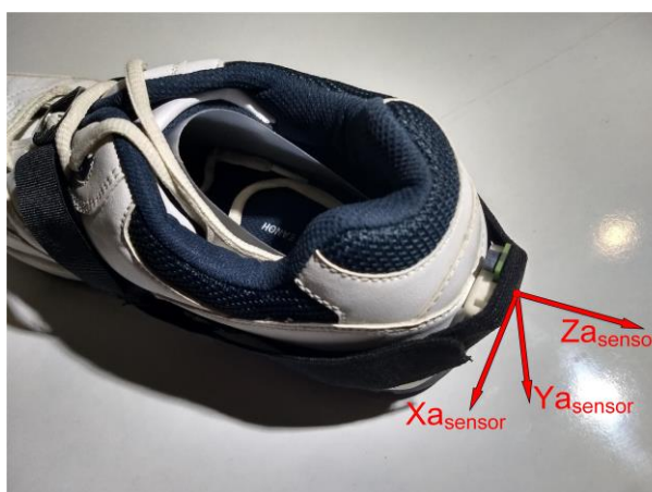
Σχήμα 4-32. Τοποθέτηση αισθητήρα στο παπούτσι (λεπτομέρεια - άξονες).
