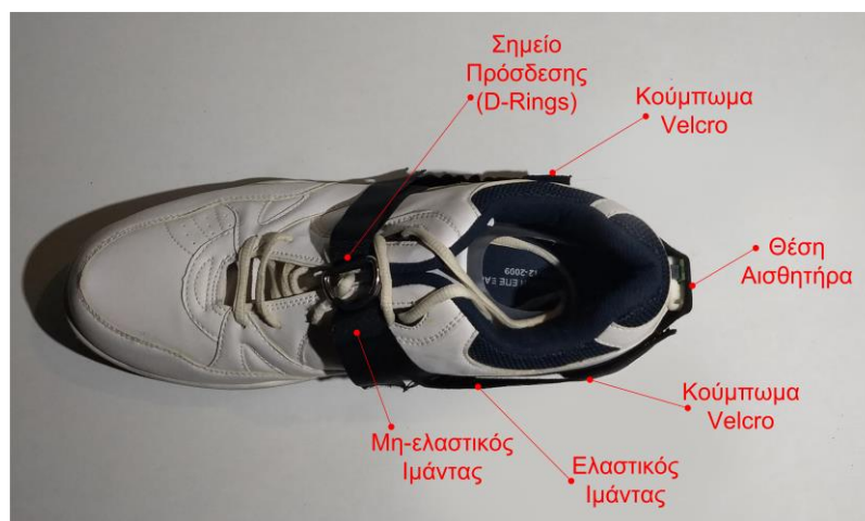
Σχήμα 4-31. Διάταξη πρόσδεσης αισθητήρα στο παπούτσι (επιμέρους στοιχεία).
