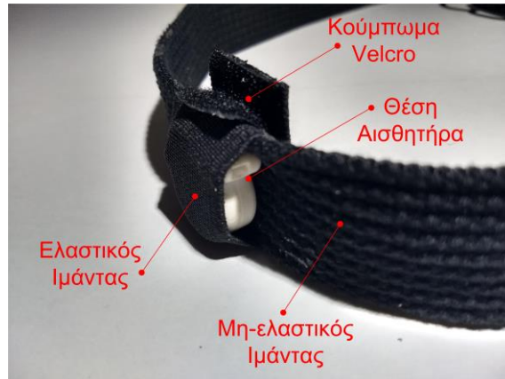
Σχήμα 4-34. Διάταξη πρόσδεσης αισθητήρα στη μέση (επιμέρους στοιχεία).
