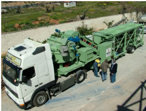
Εικόνα 4.7: Αυτοκινούμενη μονάδα Παραγωγής σκυροδέματος
