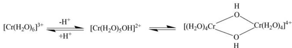
Σχήμα 2.6: Συμπύκνωση του [\text{Cr}(\text{H}_2\text{O})_6]^{3+} μέσω του σχηματισμού των υδροξο-γεφυρών (Saha and Orvig, 2010)
