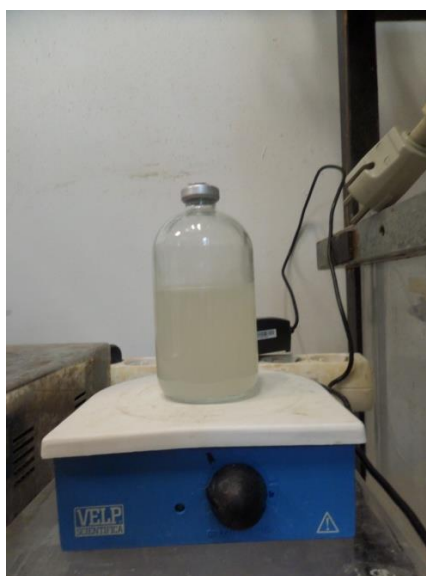
Σχήμα 3.8: Χρησιμοποιούμενος αντιδραστήρας στα batch πειράματα προσδιορισμού του Υ και του I.H
