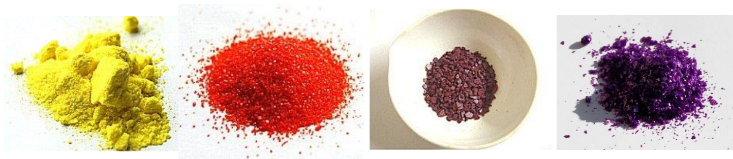
Σχήμα 2.5: Τυπικά παραδείγματα ενώσεων εξασθενούς και τρισθενούς χρωμίου -από αριστερά προς δεξιά: χρωμικό κάλιο ( K_2CrO_4 ), διχρωμικό κάλιο ( K_2Cr_2O_7 ), τριοξείδιο του χρωμίου ( CrO_3 ), τριχλωριούχο χρώμιο ( CrCl_3 ) (EEX)
