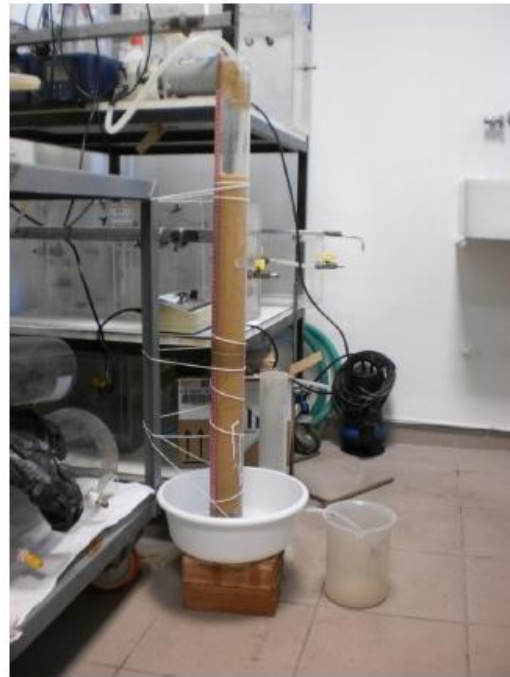
Σχήμα 3.12: Γεωμετρία αμμόφιλτρου και χρησιμοποιούμενη διάταξη
