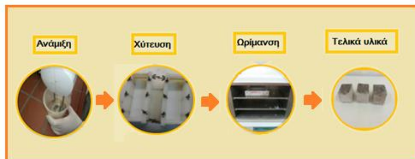
Σχήμα 8.1: Διάγραμμα ροής σύνθεσης γεωπολυμερών πολτών
