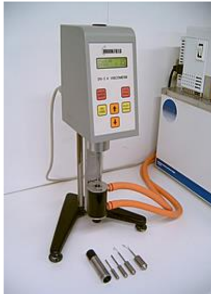
Εικόνα 8.3: Συσκευή Brookfield Viscometer LV+ για μέτρηση ιξώδους γεωπολυμερούς πολτού
