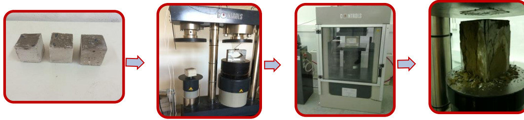
Σχήμα 8.13: Σχηματική απεικόνιση σταδίων μέτρησης αντοχής γεωπολυμερών κυβικών δοκιμίων
