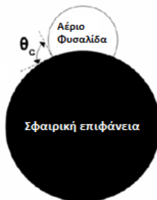
Σχήμα 5.7: Πυρηνοποίηση φυσαλίδας σε σωματίδιο σφαιρικού σχήματος (Wilt, 1986., Cole, 1974., Blander, 1979., Fisher, 1948., Fletcher, 1958)
