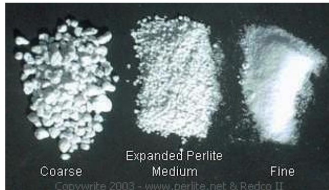
Εικόνα 3.1: Χαρακτηριστική εικόνα (από αριστερά προς δεξιά) ακατέργαστου, διογκωμένου και υπέρλεπτου περλίτη
