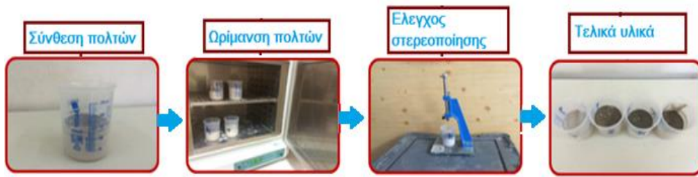
Σχήμα 8.2: Σχηματική απεικόνιση μελέτης χρόνου στερεοποίησης του γεωπολυμερούς πολτού
