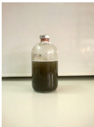
Εικόνα 5.1. Αντιδραστήρας διαλείποντος έργου (φιαλίδιο τύπου serum vial).
