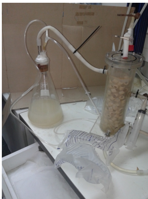
Εικόνα 5.3. Η πειραματική διάταξη του συνεχούς οξεογόνου αντιδραστήρα με ανοδική ροή για παραγωγή υδρογόνου.
