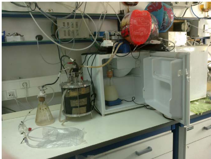
Εικόνα 5.4. Η πειραματική διάταξη του συνεχούς αναερόβιου αντιδραστήρα για παραγωγή μεθανίου.
