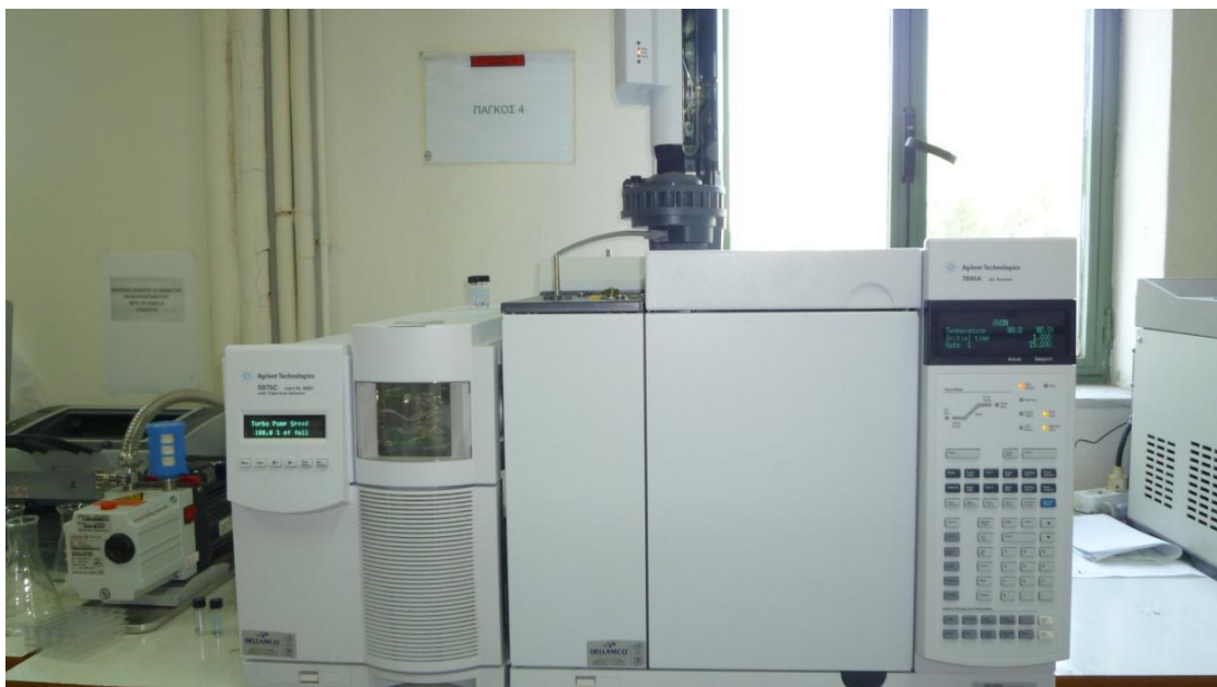
Εικόνα 6.2: GC τύπου 7890A και MS τύπου 5975C (Agilent Technologies)
