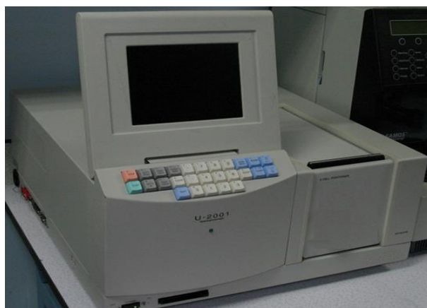
Εικόνα 6.8: Φασματοφωτόμετρο (Hitachi U 2001 UV/VIS Spectrophotometer)
