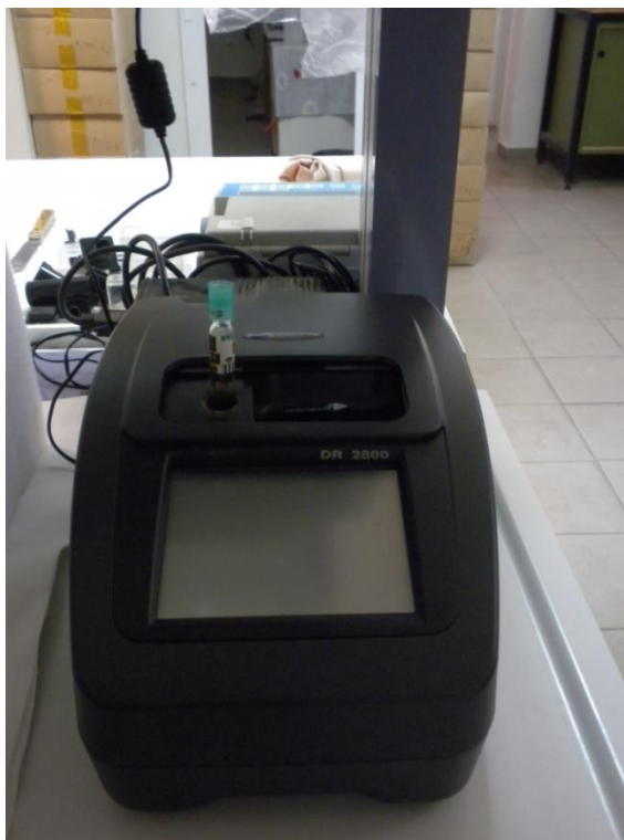
Εικόνα 6.4: Φασματοφωτόμετρο ορατού φωτός (HACH DR2800)
