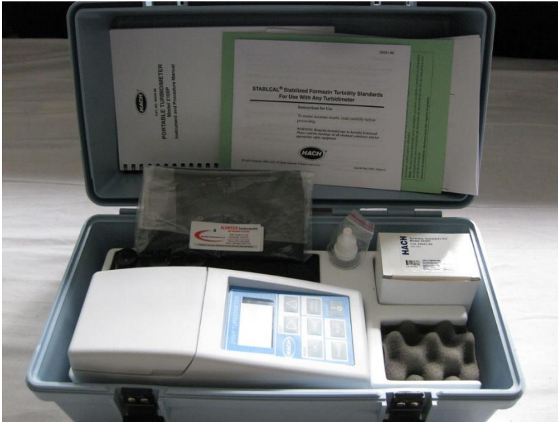
Εικόνα 6.5: Φορητό θολόμετρο (HACH Turbidity meter 2100P-ISO)
