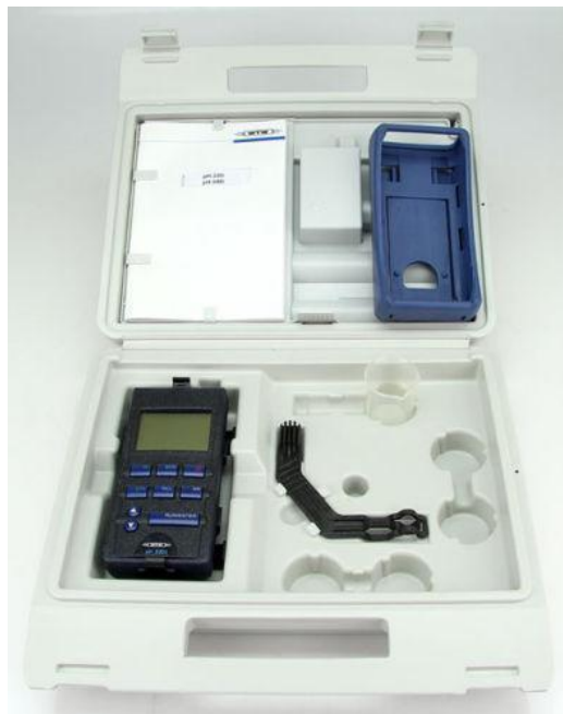
Εικόνα 6.6: Φορητό pHμετρο (WTW/315 SENTIX 41Ph)
