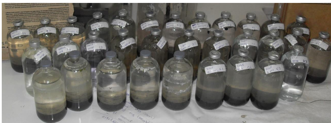
Εικόνα 6.15: Διάταξη αναερόβιων πειραμάτων
