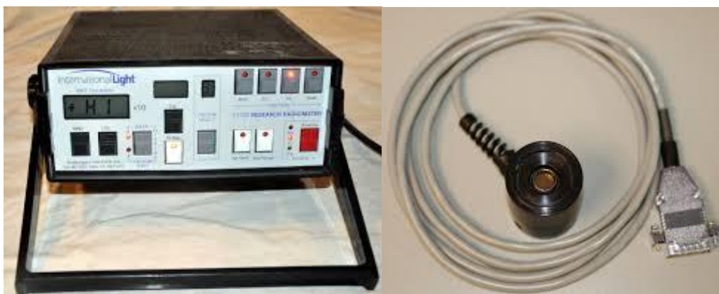
Εικόνα 6.9: (α) Ραδιόμετρο (IL 17000) και (β) ανιχνευτής UV ακτινοβολίας (SED 240)
