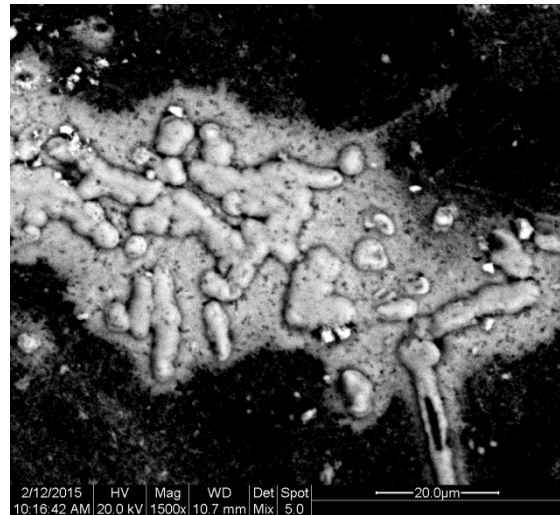
Μικρογραφία 6.14 : Συμπλέγματα κόκκων - ράβδων (μεγέθυνση x1500)
