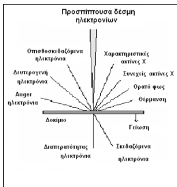
Σχήμα 4.3: Φαινόμενα αλληλεπίδρασης δέσμης – δείγματος
