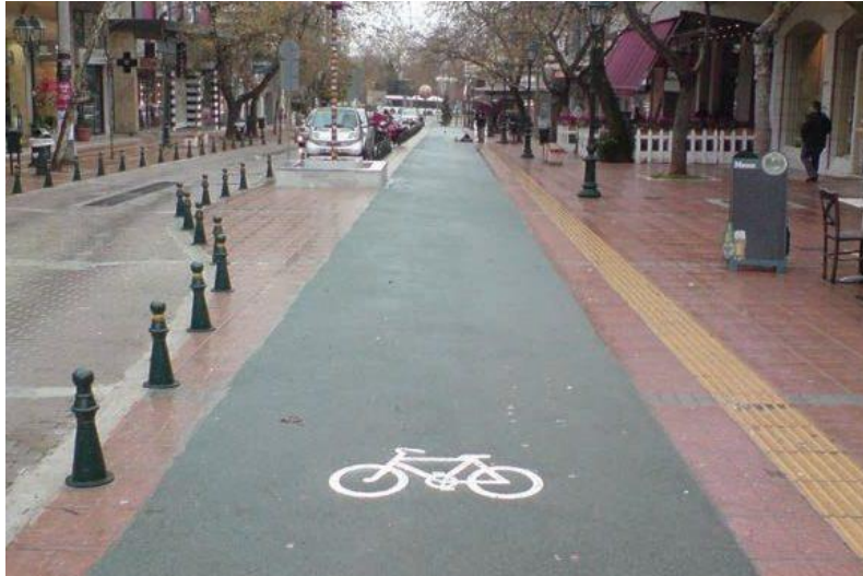
Εικόνα 2. 6: Κηφισιά. Δρόμος ήπιας κυκλοφορίας με ενιαία στάθμη. Η κίτρινη ζώνη όδευσης τυφλών λειτουργεί ως όριο μεταξύ λωρίδας ποδηλάτου και πεζοδρόμου.
