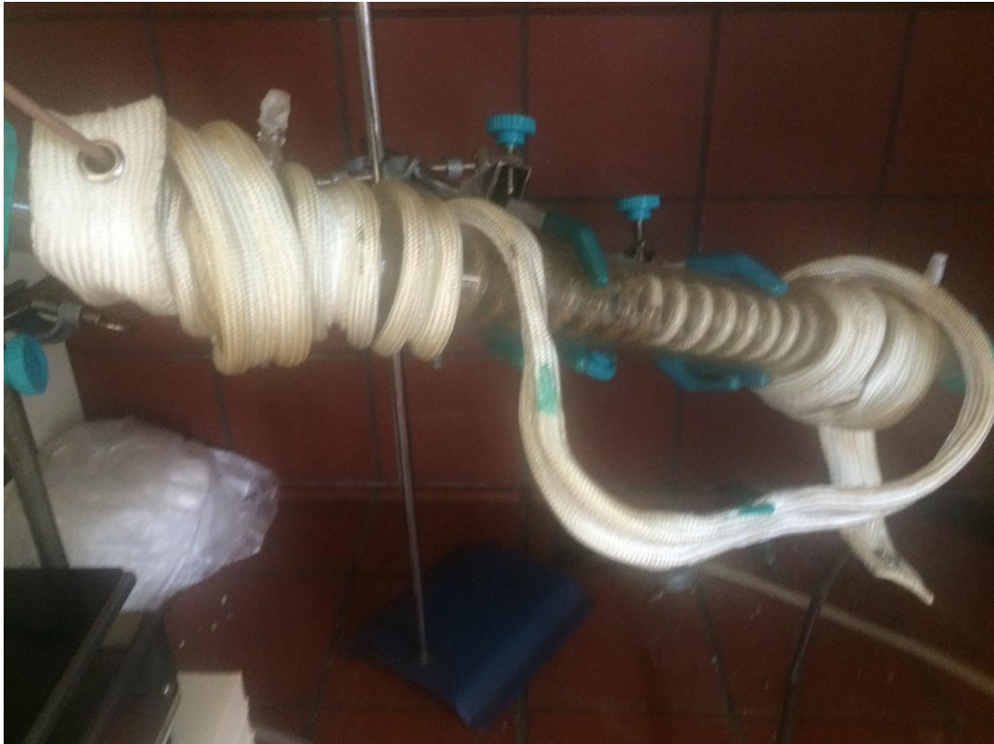
Εικόνα Π-4: Η ταινία τοποθετημένη στην είσοδο και έξοδο του ψυκτήρα
