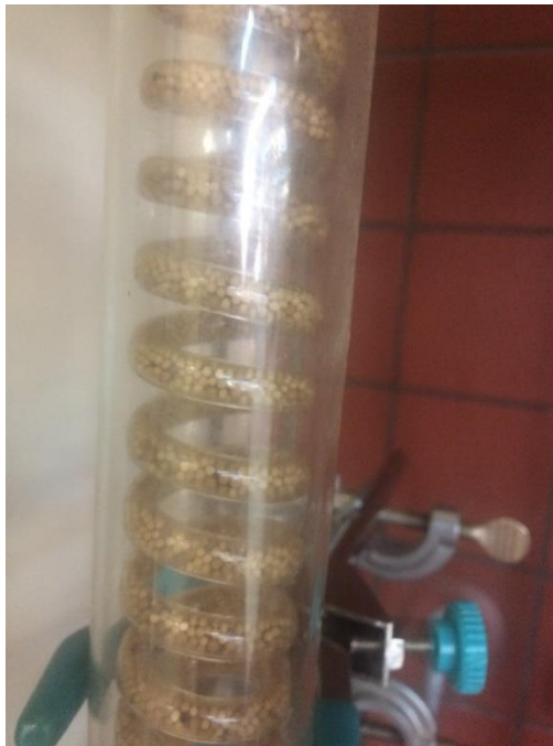
Εικόνα Π-6: Σε μεγέθυνση η μεταφορά ατμού δια μέσου των μοριακών κοσκίων
