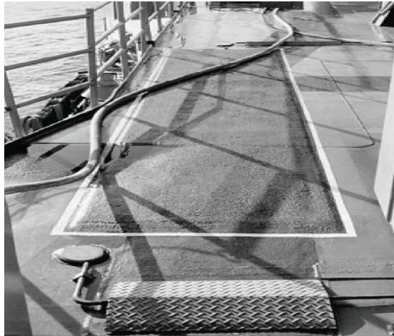
Σχήμα 1.7: Επίθεμα τοποθετημένο στο κατάστρωμα υπερκατασκευής
