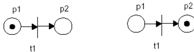
Εικόνα 3-3 Δίκτυο Petri Πριν (αριστερά) και Μετά (δεξιά) την ενεργοποίηση μετάβασης (firing)
