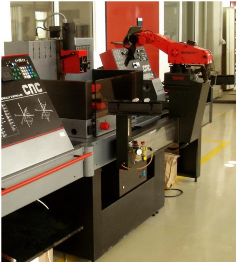
Εικόνα 2-1 Κύτταρο Κατεργασιών Εργαστηρίου
