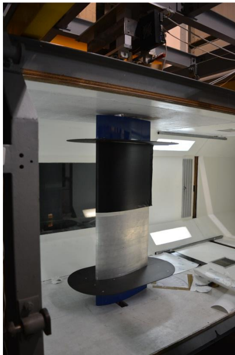
Σχήμα 4.2.1: Κατά τη διαδικασία καλυψης της πτέρυγας
