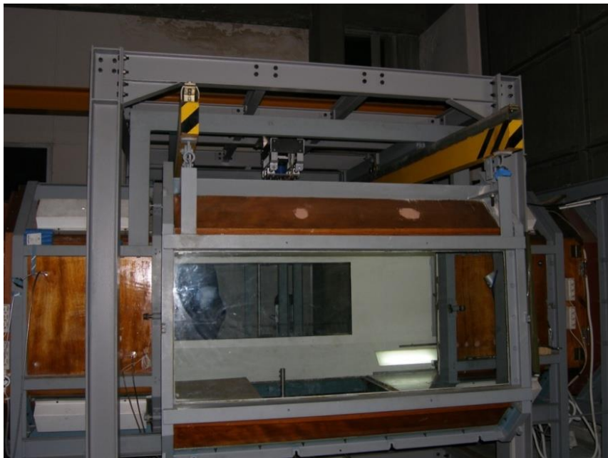
Σχήμα 4.1: Τμήμα δοκιμών αεροδυναμικής σήραγγας Ε.Μ.Π.
