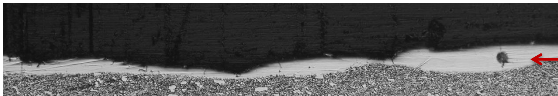
Εικόνα 66 65 Εικόνες από οπτικό μικροσκόπιο τομής κατεργασμένης σε EDM επιφάνειας χάλυβα AISI O1 με I_p=27[A] και T_{on}=300[\mu sec] σε μεγέθυνση \times 100
