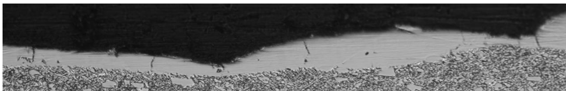
Εικόνα 67 Ρωγμές που σχηματίζονται στο WL με μεγέθυνση α) \times 500 και β) \times 200 . Διακρίνονται ρωγμές που διαπερνούν όλο το πάχος του WL και άλλες που περιορίζονται σε μέρος αυτού (συνθήκες κατεργασίας I_p=27[A] και T_{on}=300[\mu sec] )
