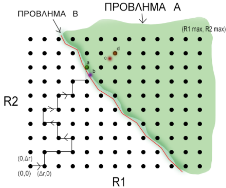
Σχήμα 5: Στο σχήμα αυτό παρουσιάζεται ο χώρος καταστάσεων για ένα πρόβλημα με δύο αισθητήρες. Παράλληλα βλέπουμε μια εξέλιξη ενός βηματικού αλγόριθμου που ξεκινάει από την μηδενική κατάσταση (R_1, R_2) = (0, 0) και καταλήγει στην κατάσταση a . Η κατάσταση a θεωρείται ελάχιστο από τις διακριτές τιμές του πλέγματος, αμέσως εντός της εφικτής περιοχής. Το b εκφράζει ένα σημείο που είναι ελάχιστο πάνω στο σύνορο της εφικτής περιοχής. Το c εκφράζει το ολικό μέγιστο σε όλη την εφικτή περιοχή. Το d εκφράζει το ολικό μέγιστο εντός της εφικτής περιοχής αλλά πάνω στην διακριτοποίηση.
