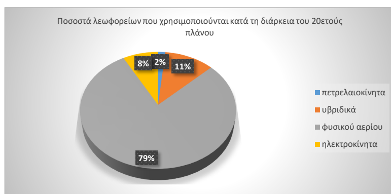
Σχήμα 5.18: Ποσοστά των διαφόρων τύπων λεωφορείων που χρησιμοποιούνται κατά τη διάρκεια του 20ετούς πλάνου για χαμηλό κόστος αγοράς λεωφορείων φυσικού αερίου
