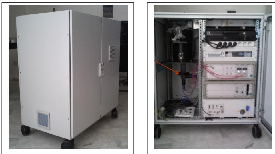
Εικόνα 4.1 Φορητό σύστημα τηλεπισκόπησης laser (σύστημα lidar) μέτρησης/καταγραφής αερολυμάτων στο Εργαστήριο Φυσικής του ΕΜΠ. (Αριστερά εξωτερική άποψη, δεξιά το εσωτερικό της συσκευής)
