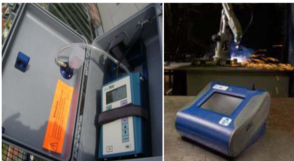
Εικόνα 5.1 Αριστερά, το DustTrak για εξωτερικούς χώρους (εσωτερική άποψη) και δεξιά, για εσωτερικούς χώρους.
