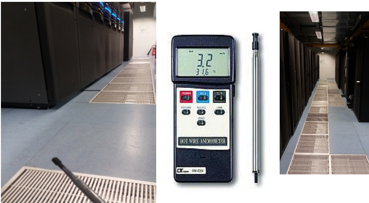
figure 5.6: Η διαδικασία των μετρήσεων, το όργανο μέτρησης της Lutron και ο «ψυχρός διάδρομος»
