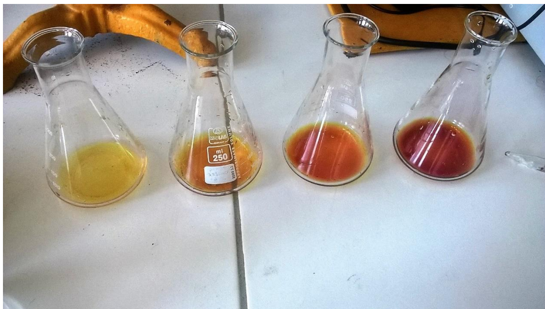
Εικόνα 2.1. Δείγματα διαλύματος υποχλωριώδων ιόντων προς τιτλοδότηση, από διαδοχικές λήψεις κατά τη διάρκεια της ηλεκτρόλυσης και με αυξανόμενη συγκέντρωση των υποχλωριώδων από την αριστερότερη προς τα δεξιότερη φιάλη.
