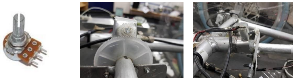
Εικόνα 7.6: Αριστερά φαίνεται το ποτενσιόμετρο που χρησιμοποιήθηκε και οι άλλες δύο εικόνες παρουσιάζουν τη βάση στήριξης του.
