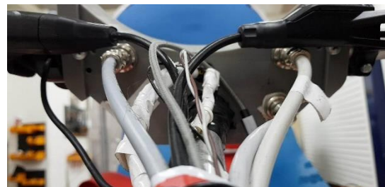
Εικόνα 7.7: Η αριστερή εικόνα παρουσιάζει τη πρόσοψη του τιμονιού και η δεξιά το πίσω μέρος και όλα τα καλώδια των υποκυκλωμάτων που εισέρχονται σε αυτό μέσω βυσμάτων.
