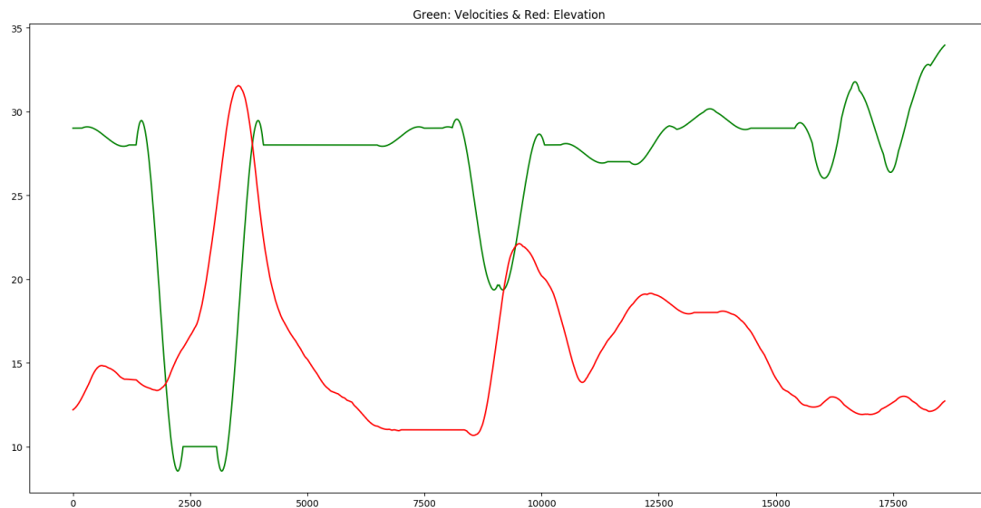
Εικόνα 5.5: Στο παραπάνω γράφημα παρουσιάζεται η επιλογή ταχυτήτων του πράκτορα με πράσινο χρώμα ενώ με κόκκινο χρώμα παρουσιάζεται το υψόμετρο της διαδρομής. Το επιθυμητό εύρος ταχυτήτων έχει οριστεί 23 \leq v \leq 27 και η ακολουθία που παρουσιάζεται έχει μέση τιμή 26.6km/h.
