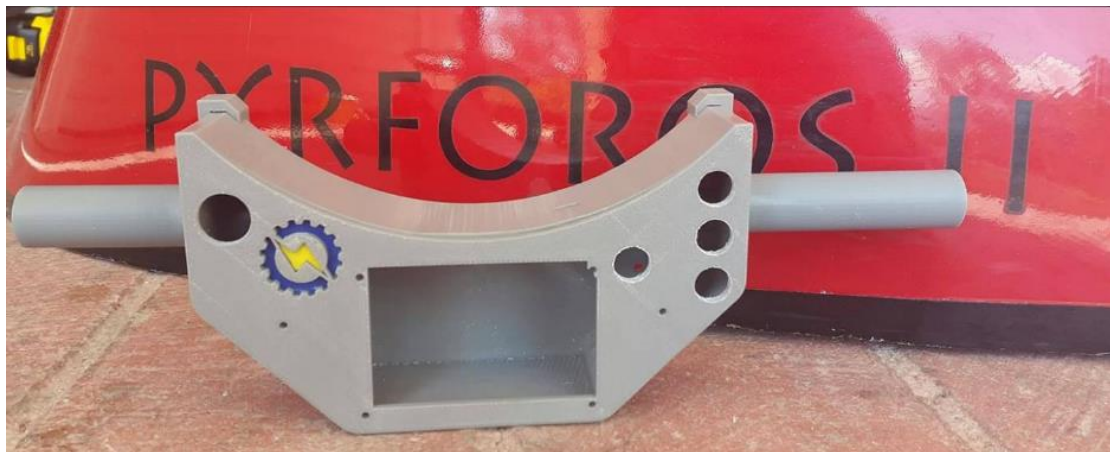
Εικόνα 2.1: Το τιμόνι του οχήματος που στεγάζει το σύστημα που παρουσιάζεται.
