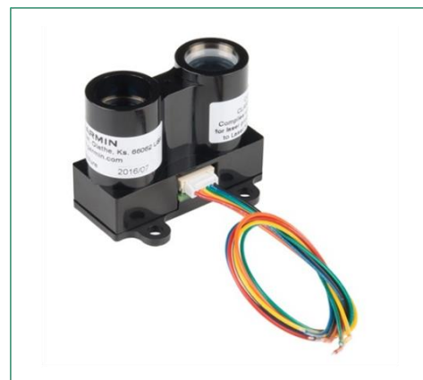
Εικόνα 2.2: Οι αισθητήρες Lidar που χρησιμοποιήθηκαν και τα σημεία τοποθέτησης τους.
