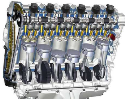
Σχήμα 4.1 – Σκαρίφημα τυπικού (εξακύλινδρου) κινητήρα σειράς
