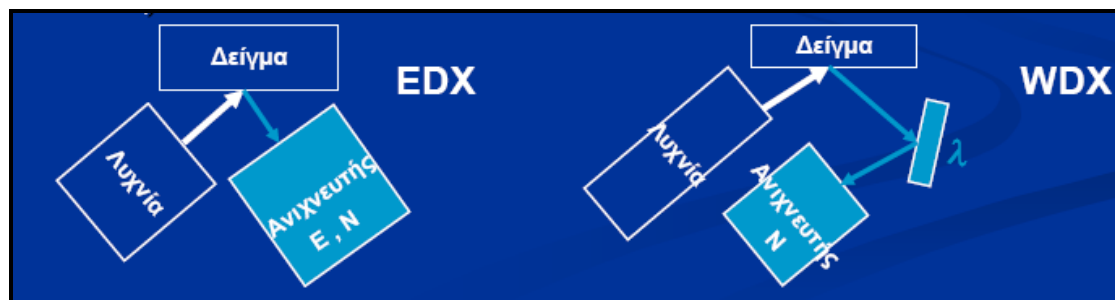
Σχήμα B.2.18: Ανάλυση του φθορισμού ακτίνων-X με διασπορά (α) ενέργειας και (β) μήκους κύματος.
