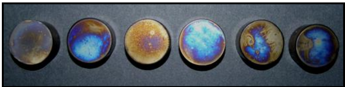
Σχήμα Β.3.32: Επικαλύψεις Ni/νάνο-ZrO 2 , οι οποίες (από αριστερά προς τα δεξιά) παρασκευάστηκαν σε συνθήκες D.C. και επιλεγμένες τιμές P.C.: \nu=0,01, 0,1, 1, 10 και 100Hz, για σταθερό d.c.=70\% και κατόπιν υποβλήθηκαν σε θερμική κατεργασία.
