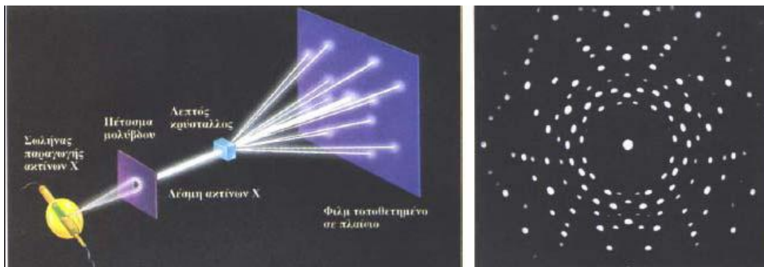
Σχήμα Β.2.8: (α) Περίθλαση ακτίνων-X κατά τη δίοδό τους από ένα κρυσταλλικό υλικό, (b) Αποτύπωμα των περιθλωμένων ακτίνων σε φωτογραφικό φιλμ [118].
