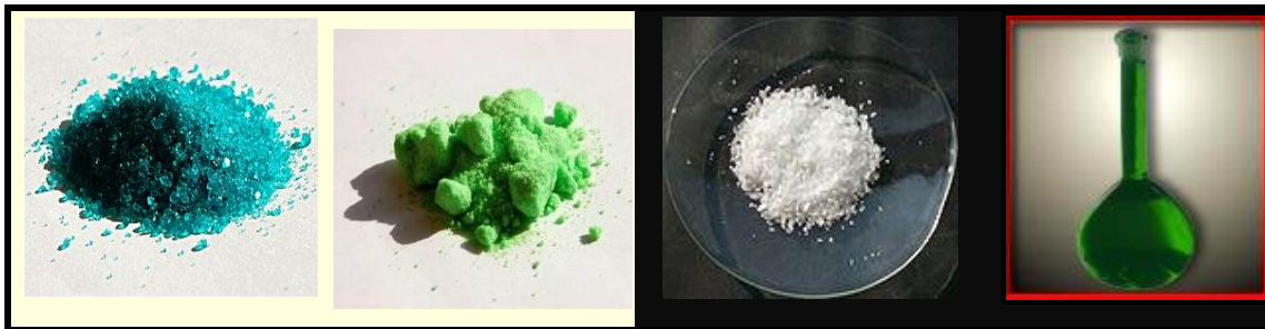
Σχήμα B.1.4: Συστατικά τυπικού λουτρού επινικέλωσης τύπου Watts (α) Επταϋδρικό (heptahydrate) άλας θειικού νικελίου (Ni(II)):NiSO 4 ·7H 2 O: 300g/L, (β) Εξαϋδρικό άλας χλωριούχου νικελίου (Ni(II)):NiCl 2 ·6H 2 O: 35g/L, (γ) Βορικό οξύ: H 3 BO 3 : 40g/L και (δ) Διάλυμα Watts
