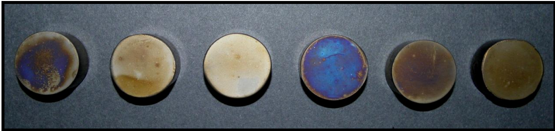
Σχήμα Β.3.30: Επικαλύψεις Ni/μίκρο-ZrO 2 , οι οποίες (από αριστερά προς τα δεξιά) παρασκευάστηκαν σε συνθήκες D.C. και επιλεγμένες τιμές P.C.: \nu=0,01, 0,1, 1, 10 και 100Hz, για σταθερό d.c.=70\% και κατόπιν υποβλήθηκαν σε θερμική κατεργασία.
