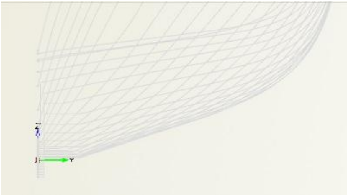
Εικόνα 4.2. Όψη στο επίπεδο y-z των νομέων σχεδίασης 397 έως το ύψος της ισάλου
