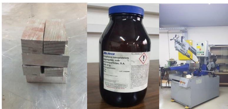
Εικόνα 7.1 (Αριστερά) Μπιγιέτα κράματος αλουμινίου 96,83%. (Κέντρο) Νανοδομές γραφενίου (GNPs). (Δεξιά) Αυτόματο πριόνι.
