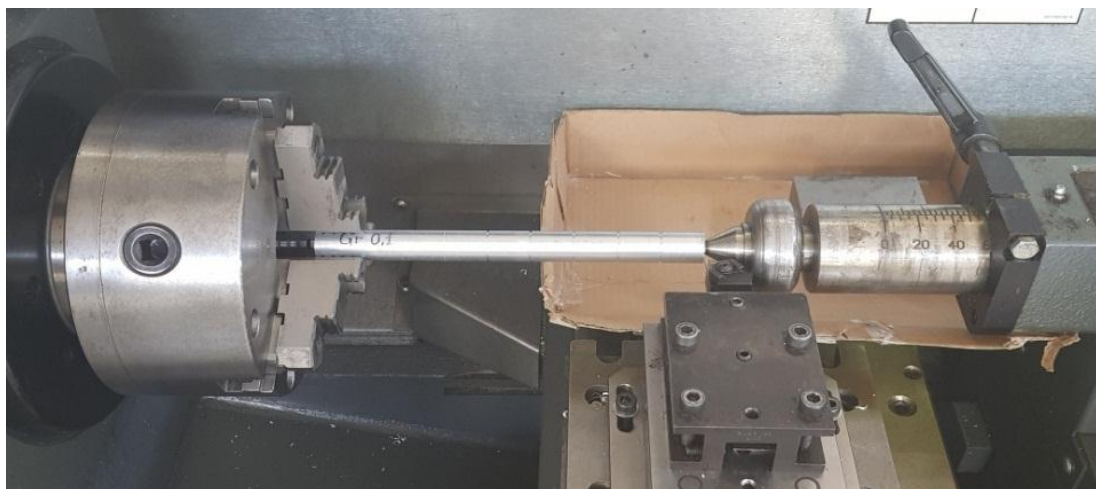
Εικόνα 8.6 Τοποθετημένο κυλινδρικό δοκίμιο στον CNC τόννο
