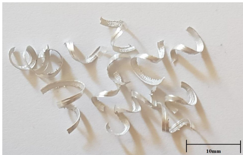
Εικόνα 8.24 Απόβλιττα αλουμινίου-GNPs 0,50% v=120m/min a_p=0,75mm f=0,1mm/rev
