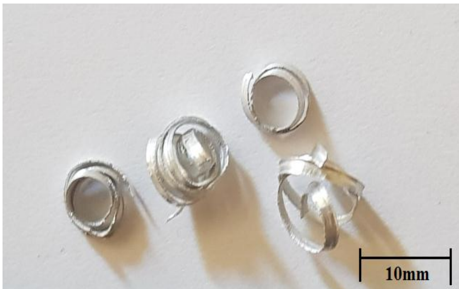
Εικόνα 8.22 Απόβλιττα αλουμινίου-GNPs 0,30% v=120m/min a_p=0,75mm f=0,1mm/rev
