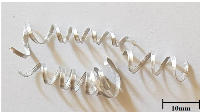
Εικόνα 8.20 Απόβλιττα αλουμινίου-GNPs 0,10% v=120\text{m/min} a_p=0,75\text{mm} f=0,1\text{mm/rev}
