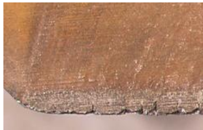
Εικόνα 5.4 Απεικόνιση φθοράς λόγω αποκολλήσεων.
