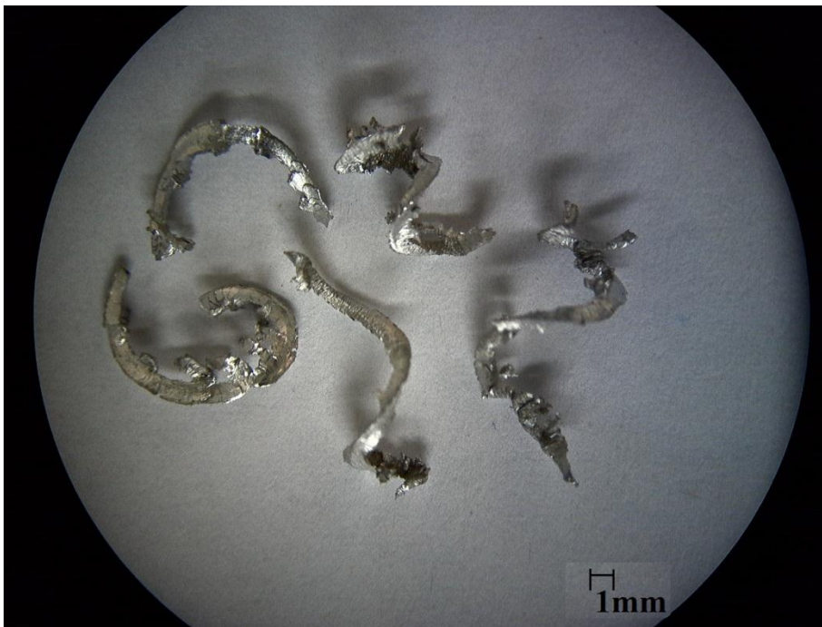
Εικόνα 8.25 Απόβλιττα αλουμινίου αναφοράς v=120m/min a_p=0,50mm f=0,3mm/rev
