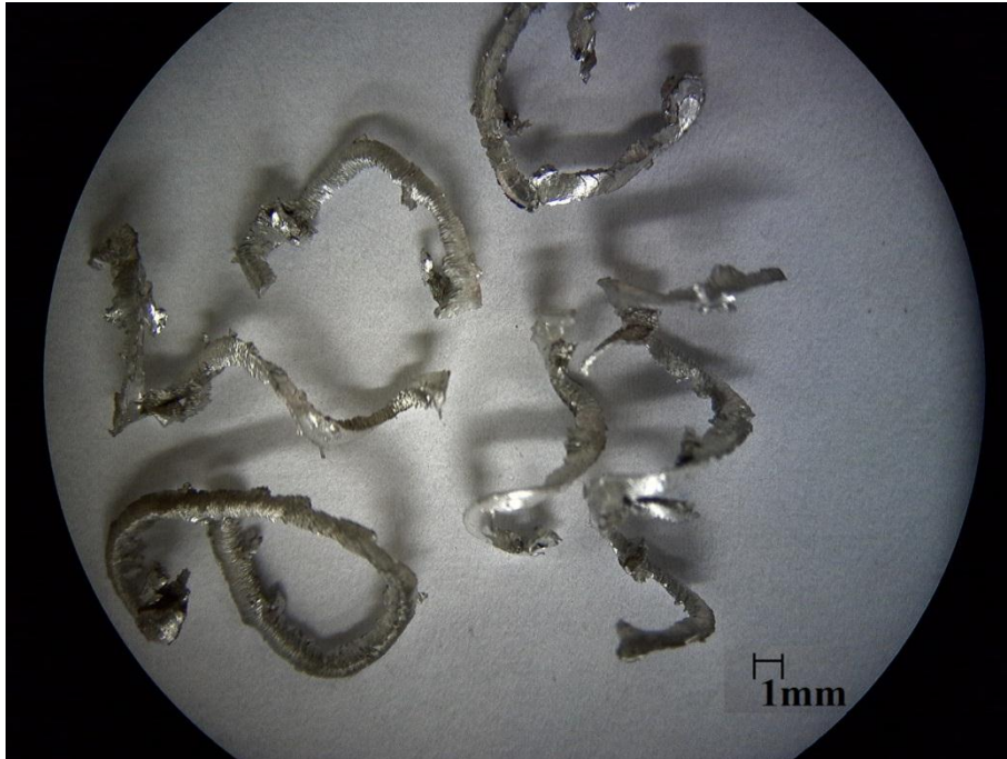
Εικόνα 8.25 Απόβλιττα αλουμινίου αναφοράς v=120m/min a_p=0,50mm f=0,3mm/rev
