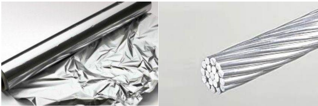
Εικόνα 1.10 (Αριστερά) Φύλο αλουμινίου για συσκευασία Al 1100 "Αλουμινόχαρτο" (Δεξιά) Καλώδιο αλουμινίου Al 1350
