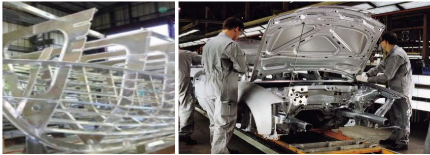
Εικόνα 1.14 (Αριστερά) Πλαίσιο σκάφους αλουμινίου Al 5754 . (Δεξιά) Φτερα και καπό αυτοκινήτου αλουμινίου Al 5252
