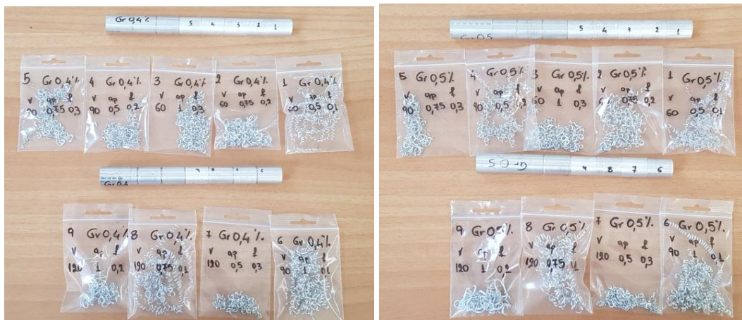
Εικόνα 8.9 Παραχθέντα κυλινδρικά δοκίμια και απόβλιττα (Αριστερά) Αλουμίνιο με περιεκτικότητα νανοδομών γραφενίου 0,40% (Δεξιά) Αλουμίνιο με περιεκτικότητα νανοδομών γραφενίου 0,50%
