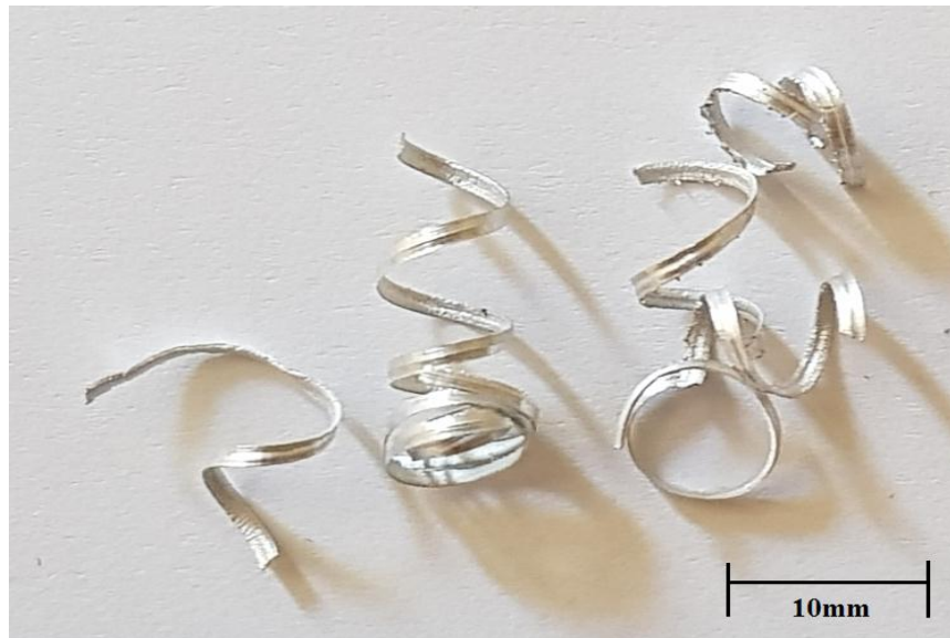
Εικόνα 8.23 Απόβλιττα αλουμινίου-GNPs 0,40% v=120m/min a_p=0,75mm f=0,1mm/rev
