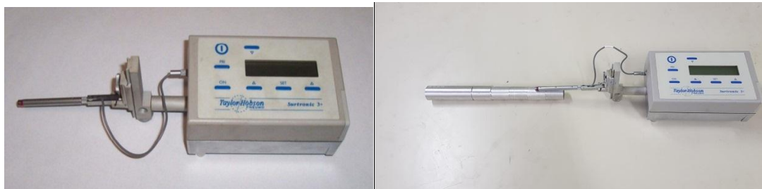
Εικόνα 8.10 (Αριστερά) Τραχύμετρο Surtronic 3+ (Δεξιά) Μέτρηση τραχύτητας στο κυλινδρικό δοκίμιο
