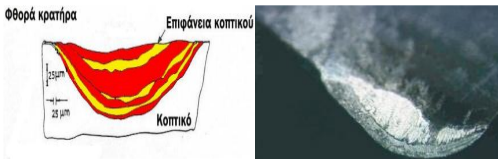
Εικόνα 5.3 (Αριστερά) Ανάπτυξη φθοράς κρατήρα στα κοπτικά εργαλεία. (Δεξιά) Απεικόνιση φθοράς κρατήρα.
