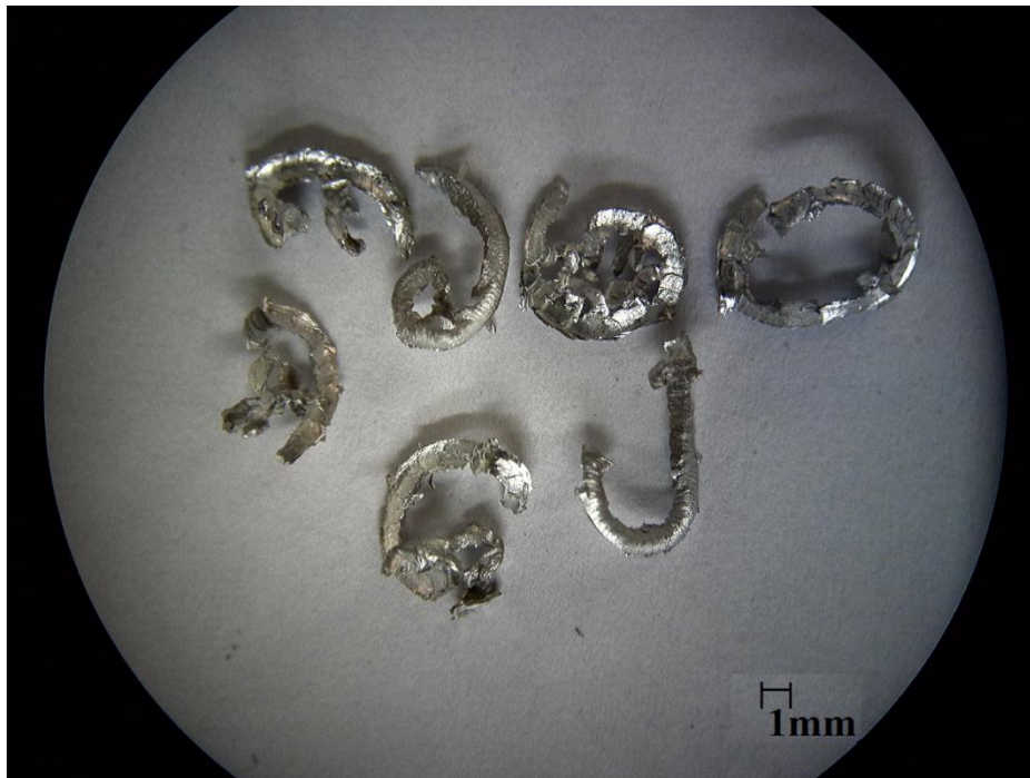
Εικόνα 8.27 Απόβλιττα αλουμινίου-GNPs 0,20% v=120m/min a_p=0,50mm f=0,3mm/rev
