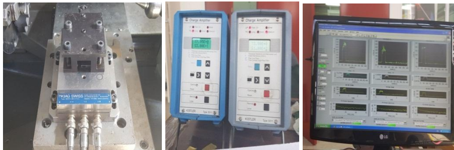
Εικόνα 8.5 (Αριστερά) Δυναμόμετρο Kistler KIAG SWISS , Type: 9257A. (Κέντρο) Ενισχυτές Kistler, Type: 5011 . (Δεξιά) Πρόγραμμα LabView διαμορφωμένο για την τόνρευση
