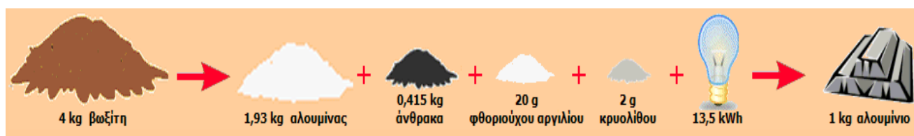
Σχήμα 1.3 Οι απαιτούμενες ποσότητες των διαφόρων υλικών και ενέργειας για την παραγωγή 1 kg αλουμινίου.
