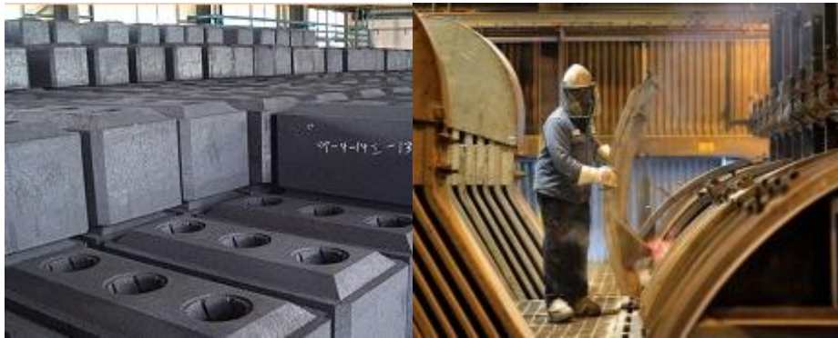
Εικόνα 1.7 (Αριστερά) "Προ-ψημένες" άνοδοι από ανθρακούχο μίγμα έτοιμες για χρήση. Το βάρος κάθε ανόδου μπορεί να φθάνει τα 600 έως 800 kg. (Δεξιά) Τεχνικός ανοίγει ένα ηλεκτρολυτικό στοιχείο για να αντικαταστήσει μια άνοδο.
