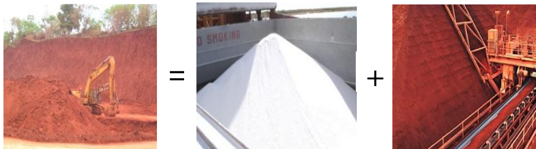
Εικόνα 1.5 Διεργασία Bayer (Αριστερά) Βωξίτης. (Κέντρο) Καθαρή αλουμίνα Al_2O_3 (Δεξιά) Κόκκινη λάσπη (κυρίως Fe_2O_3 ).
