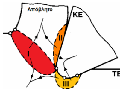
Εικόνα 4.6 Ζώνες παραγωγής θερμότητας κατά την κοπή
