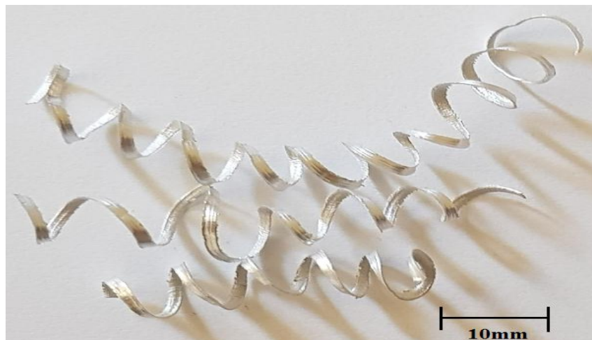
Εικόνα 8.19 Απόβλιττα αλουμινίου αναφοράς v=120\text{m/min} a_p=0,75\text{mm} f=0,1\text{mm/rev}
