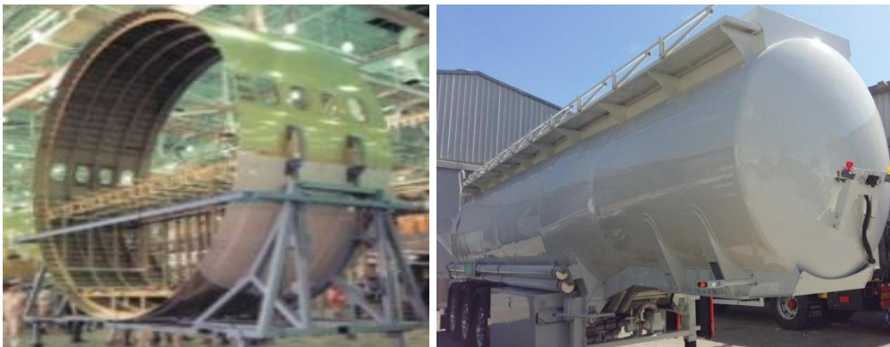
Εικόνα 1.11 (Αριστερά) Επένδυση με φύλλα αλουμινίου Al 2024 σε αεροσκάφος. (Δεξιά) Βυτίο επικαθήμενο καυσίμων από αλουμίνιο Al 2014
