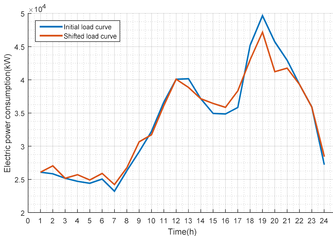
Διάγραμμα 30: Αρχική καμπύλη και τελική καμπύλη με μετατόπιση φορτίου της συνολικής κατανάλωσης της Λέσβου
