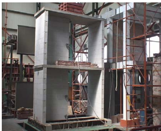
Σχήμα 7.3. Γενική άποψη δοκιμίου στο σεισμικό προσομοιωτήρα.
