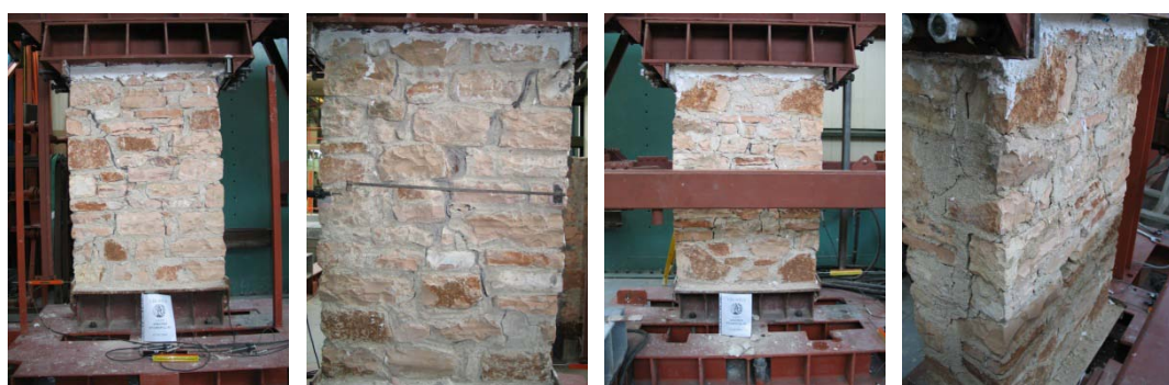
Σχήμα 5.34. Αστοχία δοκιμίων: (α): Δοκίμιο I-A - Διαγώνιες ρωγμές στην μπροστινή και πίσω στρώση του δοκιμίου και (β): Δοκίμιο I-B - Διαγώνιες ρωγμές στην μπροστινή στρώση του δοκιμίου, οριζόντιες ρωγμές κατά μήκος της διεπιφάνειας των στρώσεων.
