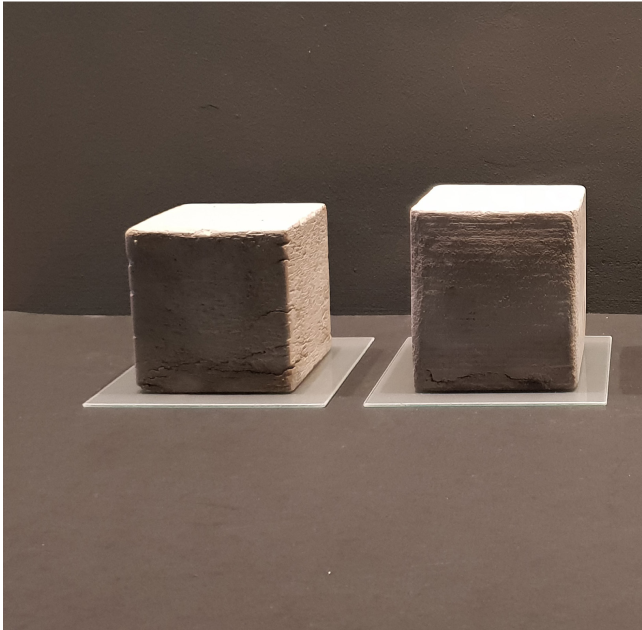
Κυβικά δοκίμια: πατητή τσιμεντοκονία, σκυρόδεμα, rummed earth, τομή εδάφους (από αρισ...
