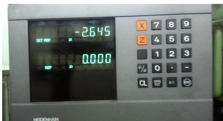
Σχήμα 4.3.4 Ψηφιακός μετρητής θέσης
