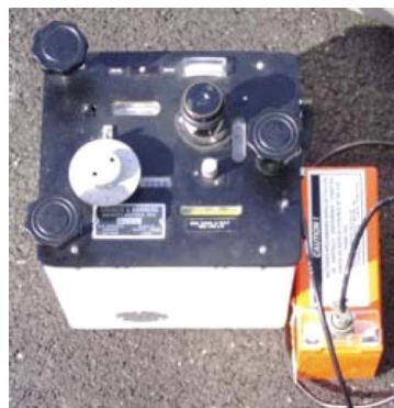
Εικόνα 2.4: Βαρυτήμετρο Scintex CG5 (αριστερά) και βαρυτήμετρο LaCoste & Romberg τύπου G (δεξιά) (πηγή: Επεξεργασία Διαχρονικών Μετρήσεων Βαρύτητας στη Ν. Θήρα, Παρασκευάς Μελισσιός, 2013)
