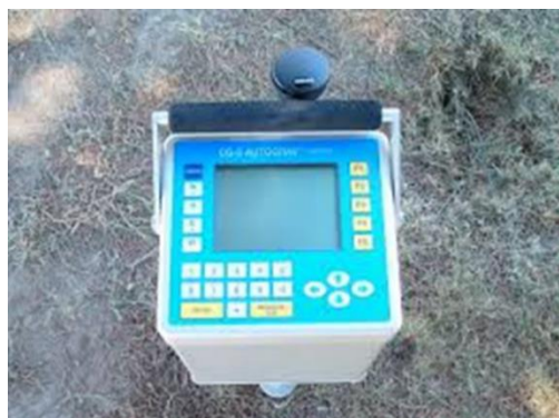
Εικόνα 2.4: Βαρυτήμετρο Scintex CG5 (αριστερά) και βαρυτήμετρο LaCoste & Romberg τύπου G (δεξιά) (πηγή: Επεξεργασία Διαχρονικών Μετρήσεων Βαρύτητας στη Ν. Θήρα, Παρασκευάς Μελισσιός, 2013)
