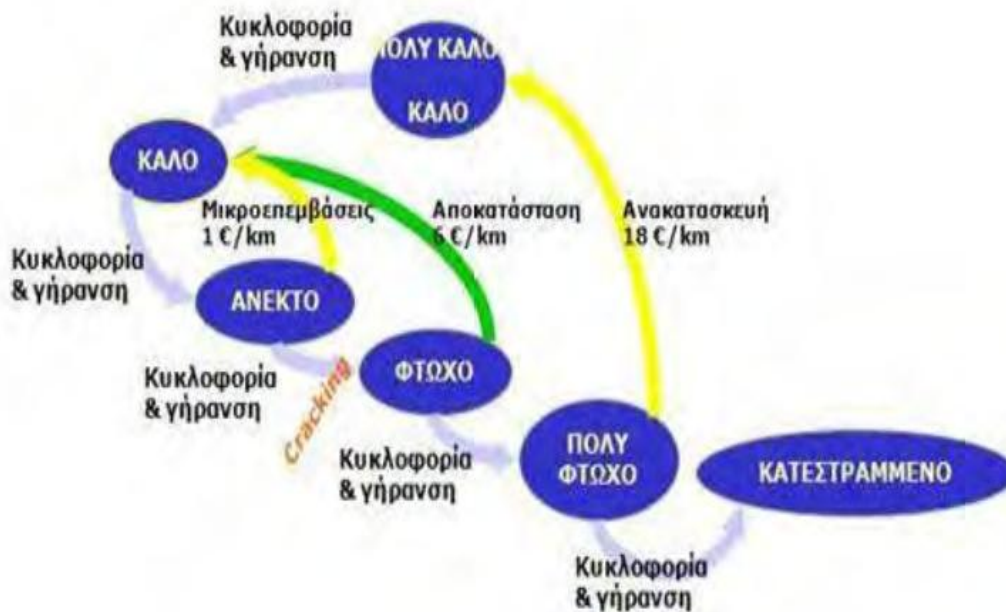
Σχήμα 3.2: Μεταβολές στην κατάσταση του οδοστρώματος
