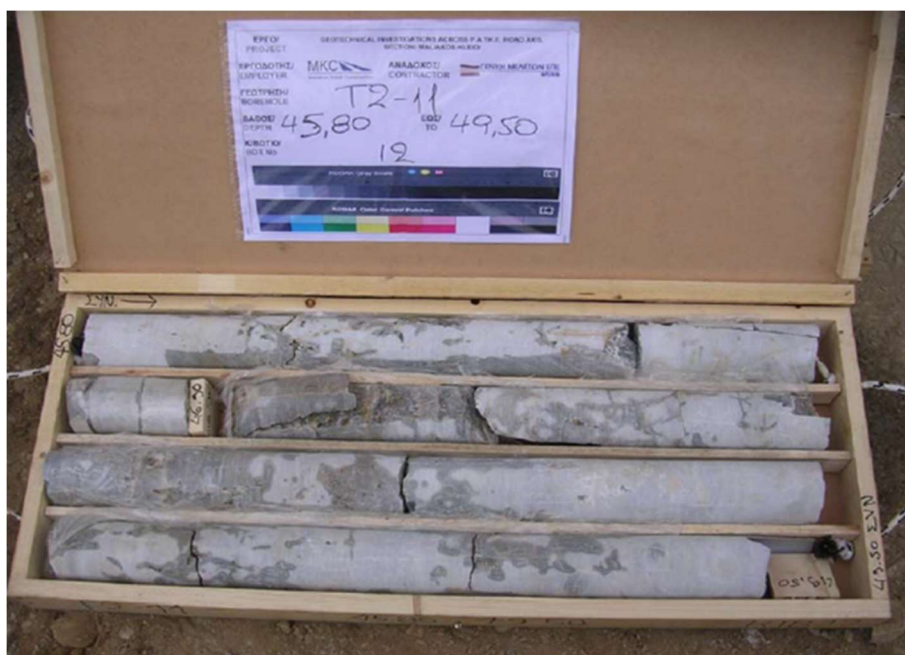
Εικόνα 3-10 Γεώτρηση T2-11: Γκρι ως λευκότεφρος κρυσταλλικός ασβεστόλιθος, καλής έως πολύ καλής ποιότητας βραχώμαζα, υγιής ως ελαφρά αποσαθρωμένος (Istria General Consulting Ltd)
