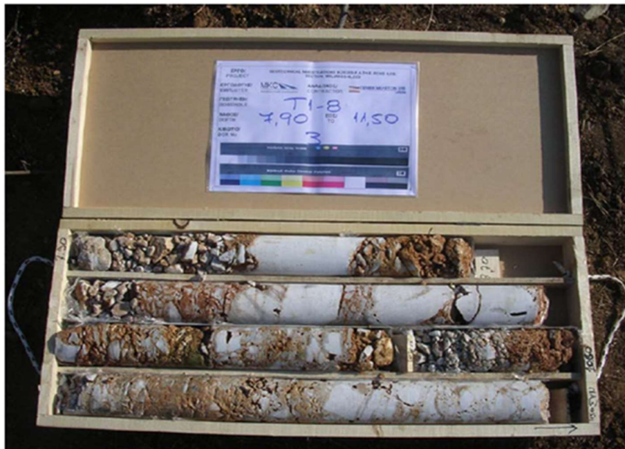
Εικόνα 3-9 Χαμηλής αντοχής ασβεστολιθικό λατυποπαγές, κατά τόπους κατακερματισμένο και καρστικοποιημένο (Istria General Consulting Ltd)
