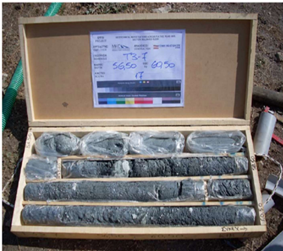
Εικόνα 3-12 Γεώτρηση T3-7, Εντελώς αποδομημένο οφιολιθικό mélange: σερπεντινωμένος περιδοτίτης ,με ολίγους χάλικες ασβεστιτικής σύστασης (Istria General Consulting Ltd)
