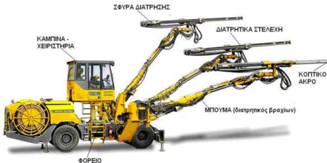
Εικόνα 2-6 Τυπικό διατρητικό jumbo υπογείων (Μπακογιάννης, 2011)
