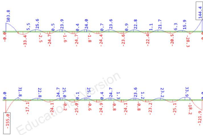
Σχήμα 7.16: Διάγραμμα ροπών κάμψης M_z κύριων δοκών για τοπική ατέλεια μέλους (άνεμος X)
