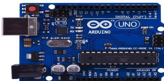
Εικόνα 3.7 Πλατφόρμα IoT Arduino Uno
