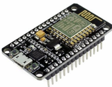
Εικόνα 3.5 - Πλατφόρμα IoT Nodemcu
