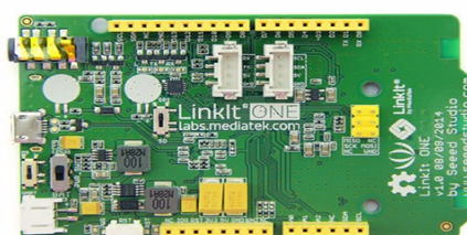
Εικόνα 3.11 Πλατφόρμα IoT LinkIt One
