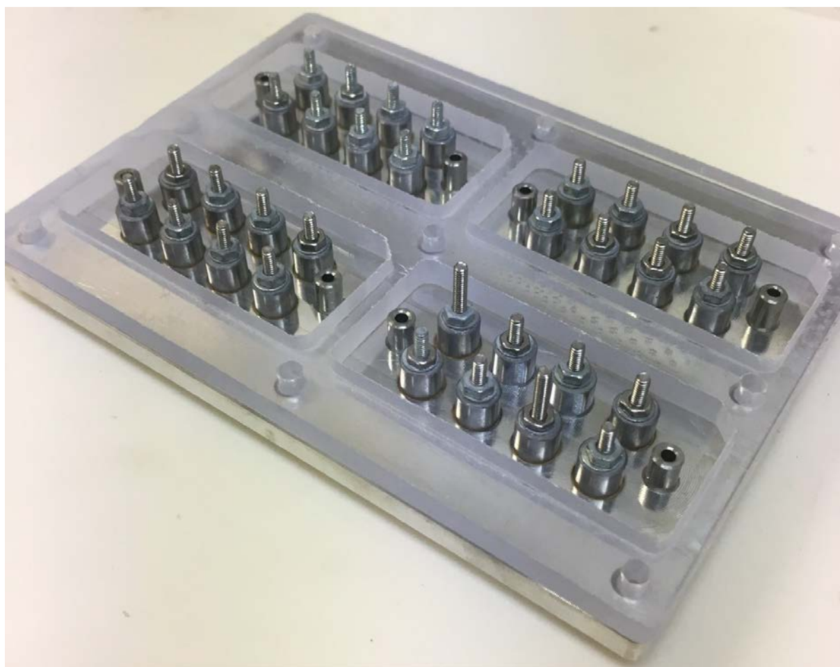
Εικόνα 47: Συναρμολογημένο καλούπι χύτευσης PDMS
