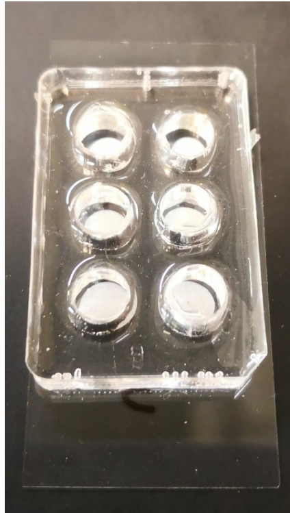
Εικόνα 1: Συσκευή με συστοιχία 6 λεπτών ΠΙΚ. Φαίνονται τα τρία μέρη της: το γυαλί μικροσκοπίας (σαν βάση), η διαφανής υπερκατασκευή με 6 βοθρία (wells) κολλημένα από πάνω και τα 6 λευκά ΠΙΚ προσκολλημένα πάνω στο γυαλί στον πάτο κάθε βοθρίου.
