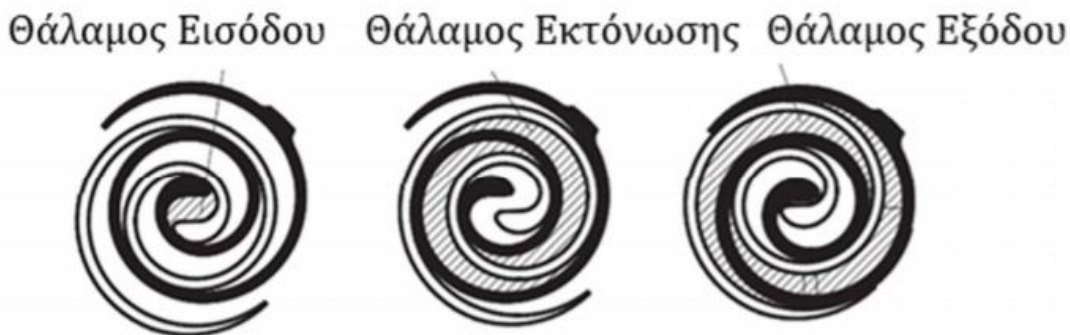
Εικόνα 18. Φάσεις εκτόνωσης σε σπειροειδή εκτονωτή.[45]
