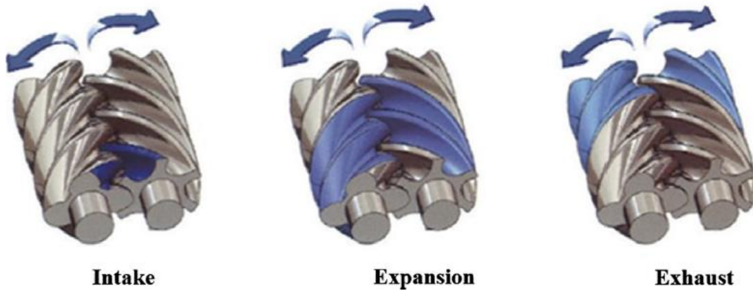
Εικόνα 21. Η αρχή λειτουργίας του ελικοειδούς εκτονωτή.
